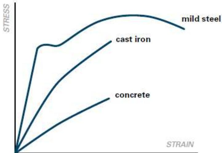
Slika 9. Dijagram naprezanja za čelik, lijevano željezo i beton [13]
