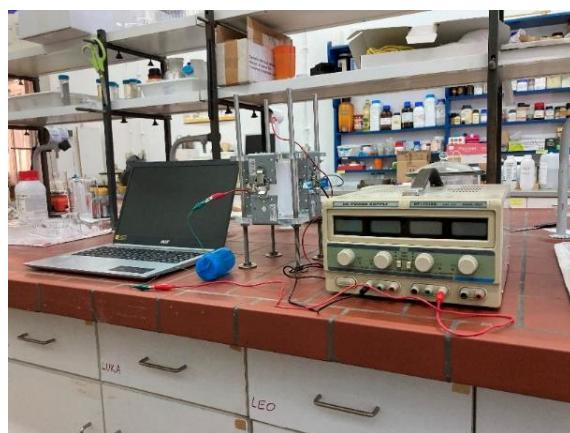
**Slika 22.** Aparatura korištena za anodizaciju
