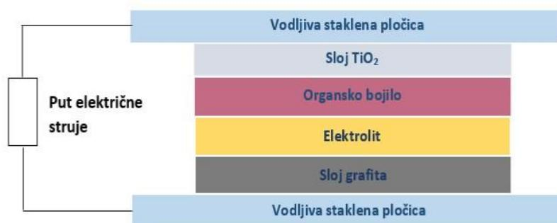
**Slika 4.** Shematski prikaz Grätzelove solarne ćelije
