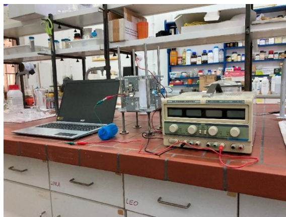
Slika 22. Aparatura korištena za anodizaciju
