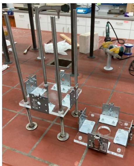
**Slika 20.** Kućište elektrokemijske celije
