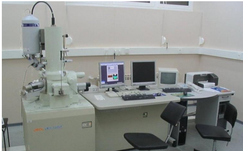
Slika 22. Visokorezolucijski pretražni elektronski mikroskop JEOL JSM-7000F [39]
