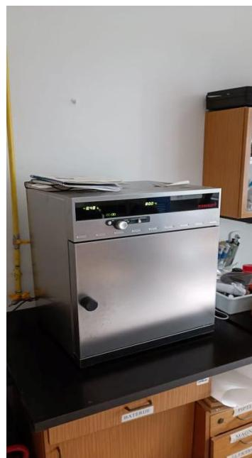
**Slika 13.** Oksidacija, adsorpcija, sušenje uzorka u peći
