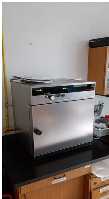
Slika 13. Oksidacija, adsorpcija, sušenje uzoraka u peći
