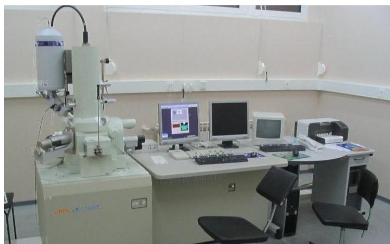
**Slika 22.** Visokorezolucijski pretražni elektronski mikroskop JEOL JSM-7000F [39]
