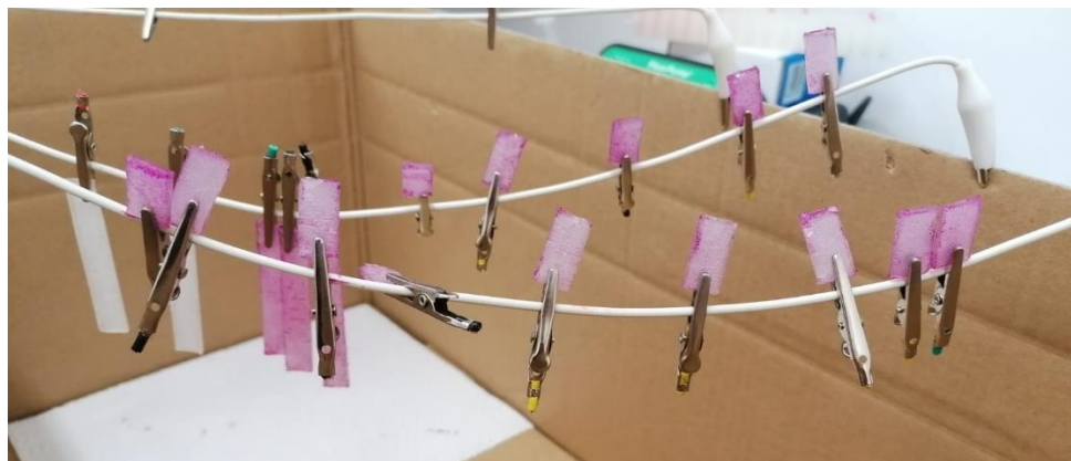
Slika 26. Sušenje pločica nakon nanošenja smjese senzorskih filmova.
