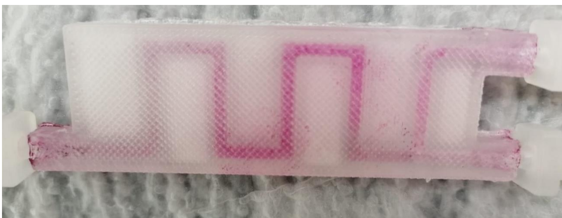
Slika 47. Milireaktor sa senzorskim filmom kroz kojeg je protjecala otopina pH-vrijednosti 5,0
