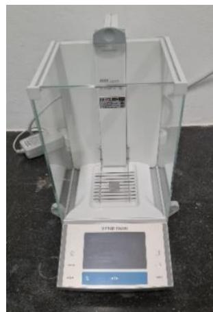
Slika 6. Analitička vaga Mettler Toledo XA105 DualRange
