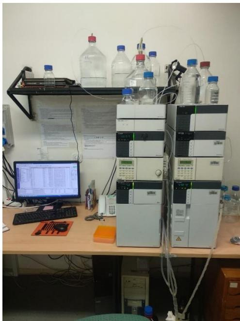
Slika 3.5. Tekućinski kromatograf visoke djelotvornosti
