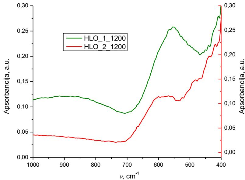
Slika 24. FTIR spektri uzoraka HLO\_1 i HLO\_2 žarenih na temepreturi od  $1200 \text{ }^{\circ}\text{C}$
