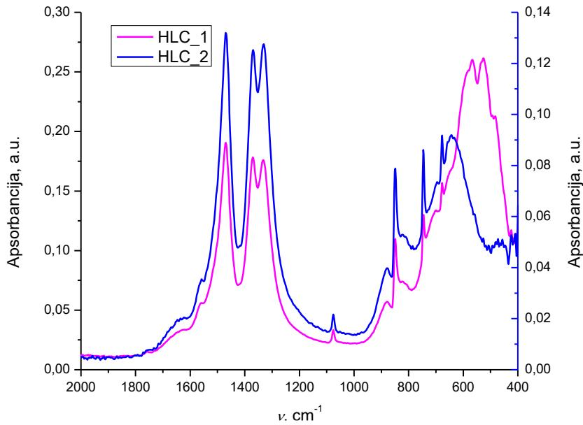
Slika 25. FTIR spektri sirovih uzoraka HLC\_1 i HLC\_2
