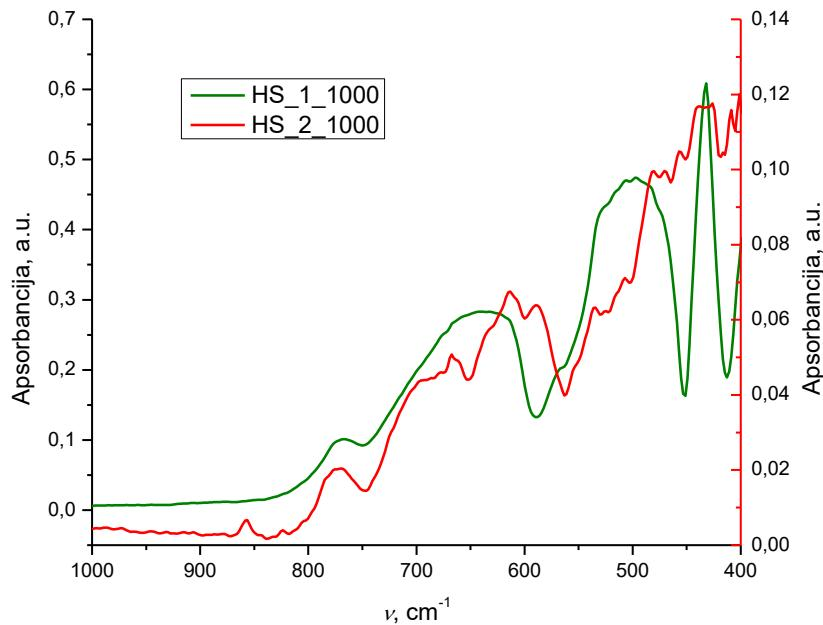
Slika 22. FTIR spektri uzoraka HS<sub>1</sub> i HS<sub>2</sub> žarenih pri temperaturi od 1000 °C
