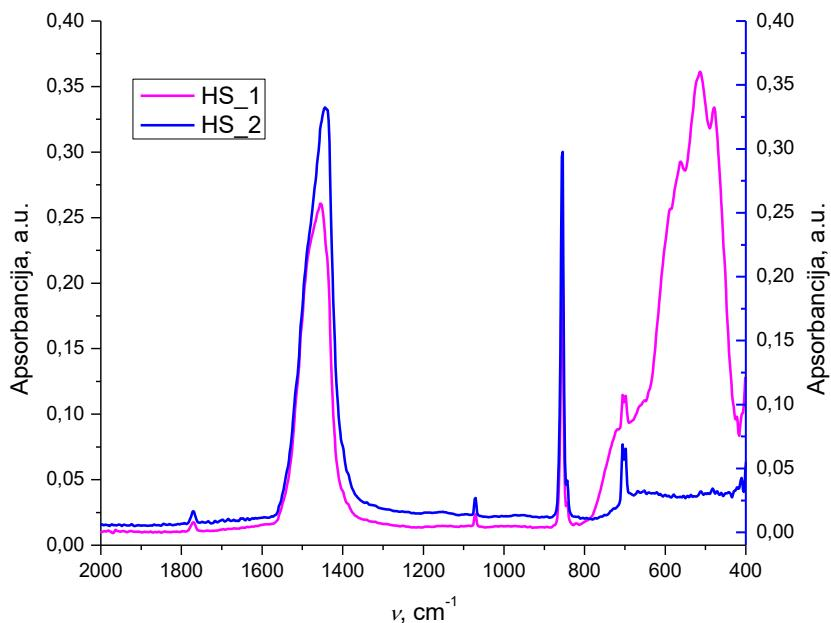
*Slika 21. FTIR spektri sirovih uzoraka HS\_1 i HS\_2*
