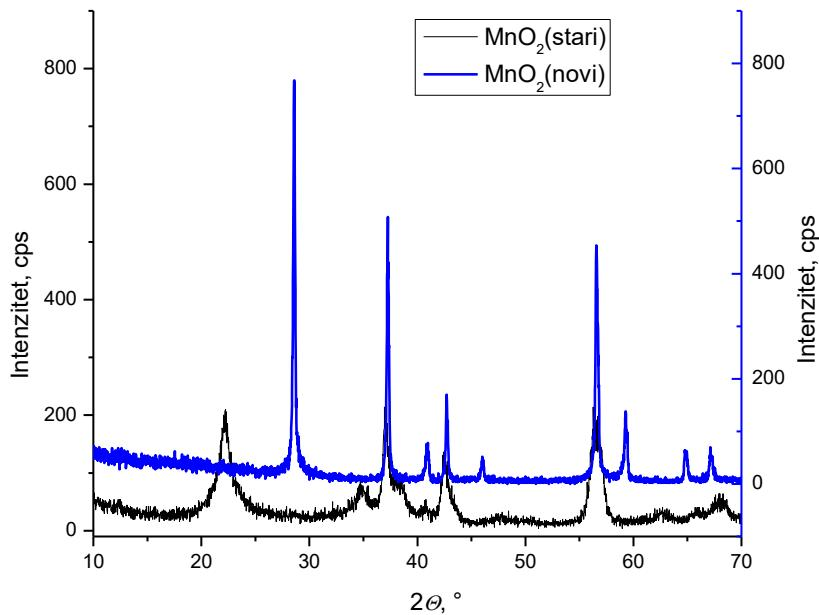
Slika 5. Rezultati rendgenske analize reaktanta  $\text{MnO}_2$
