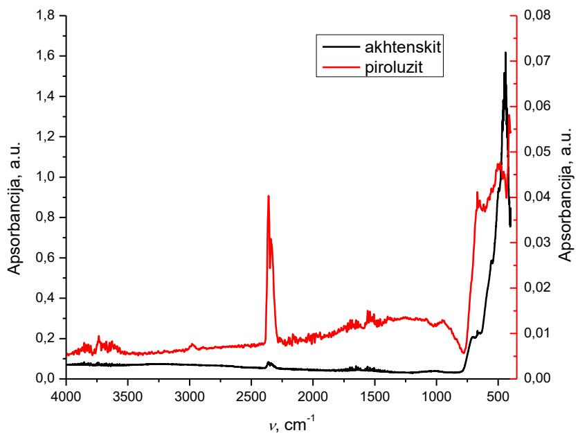
Slika 20. FTIR spektri reaktanata – akhtenskita i piroluzita
