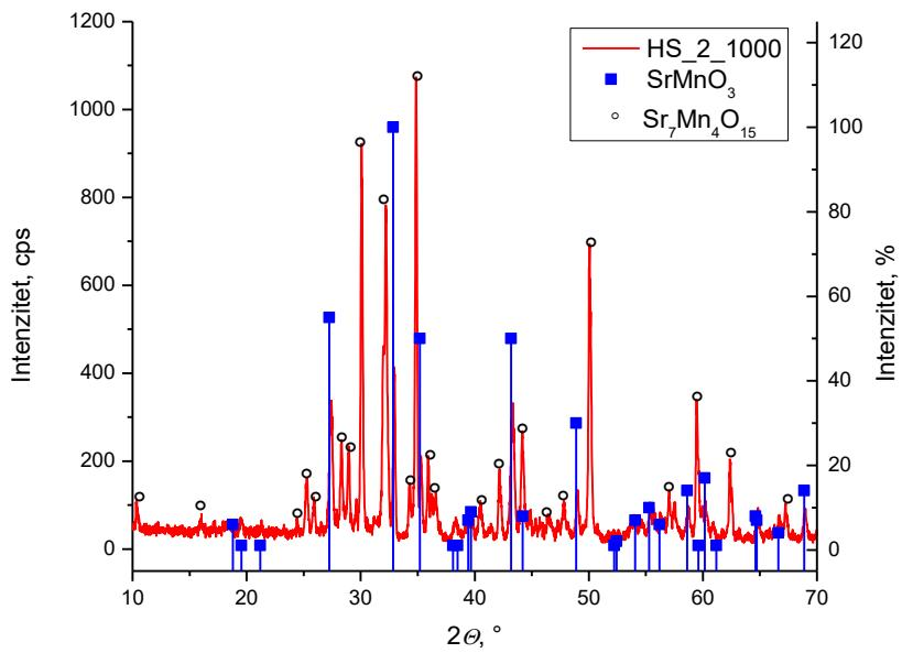
Slika 9. Usporedba sastava uzorka HS\_2 žarenog pri temperaturi od 1000 °C
