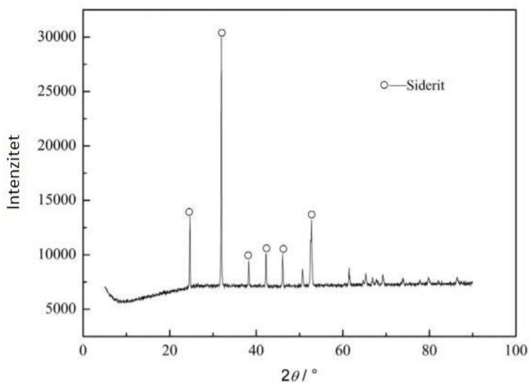
Slika 3. Izgled difraktograma na primjeru siderita [12]
