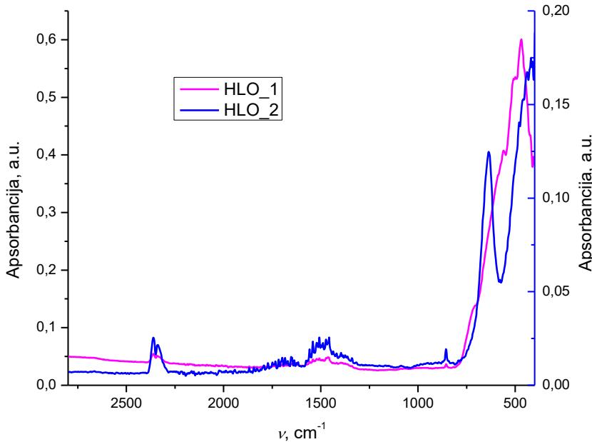
Slika 23. FTIR spektri sirovih uzoraka HLO<sub>1</sub> i HLO<sub>2</sub>
