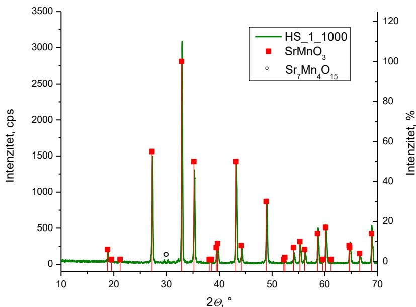
Slika 8. Usporedba sastava uzorka HS\_1 žarenog na tempereturi od 1000 °C
