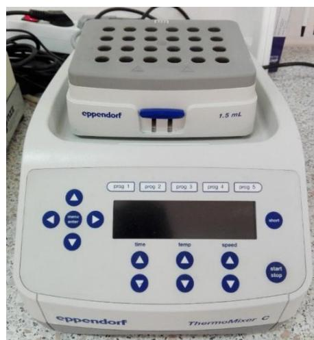
Slika 3.2. Električna tresilica ThermoMixer C.
