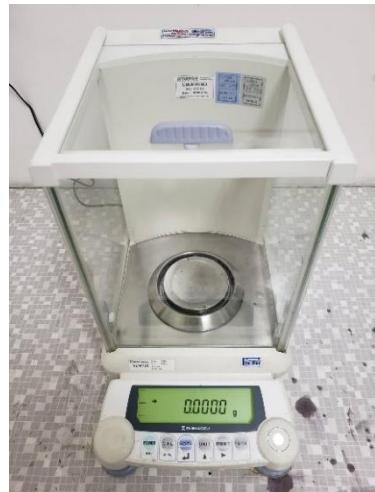
Slika 3.4. Analitička vaga na četiri decimale AU W120 Shimadzu.
