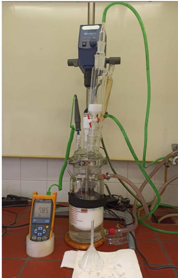
Slika 10. Aparatura za proces emulzijske polimerizacije
