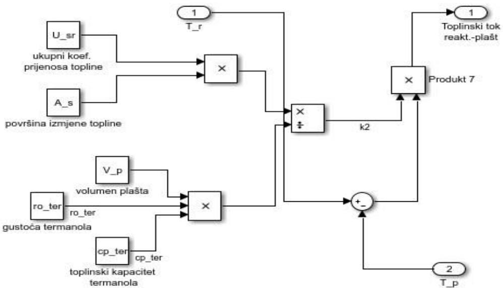
Slika 4.10. Izmjena topline između plašta i reaktora
