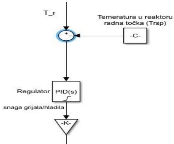
Slika 4.13. Regulator s ulaznim i izlaznim signalima
