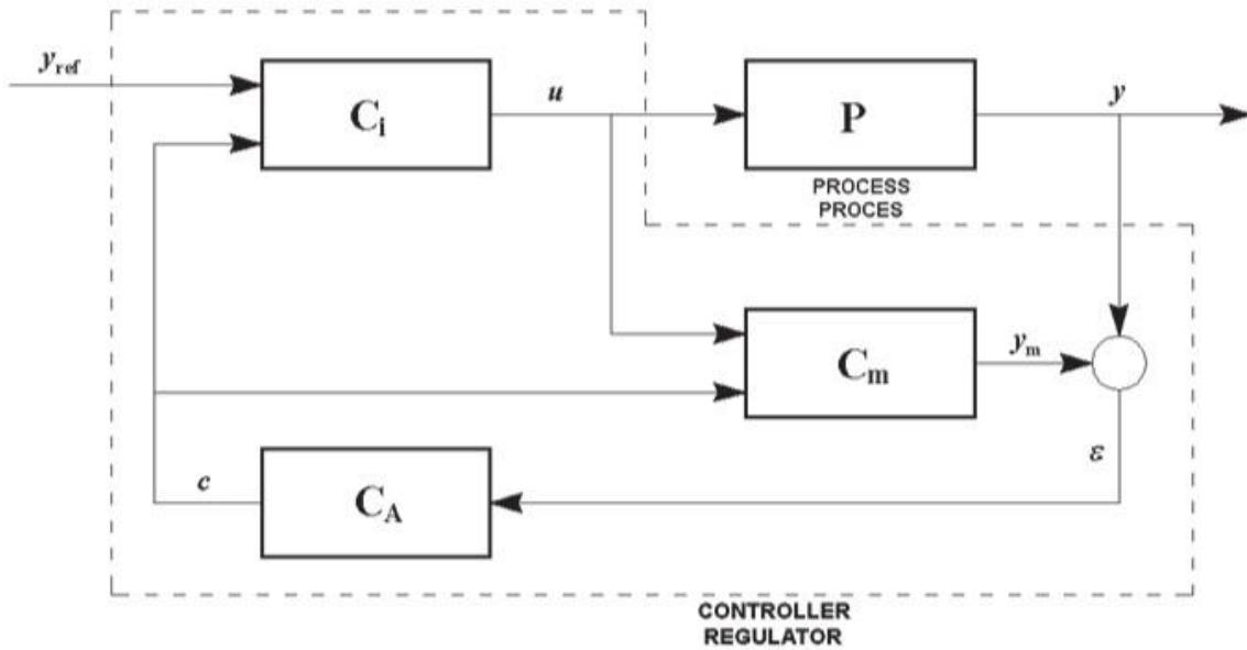
**Slika 2.13.** Shematski prikaz vođenja procesa temeljenog na modelu
