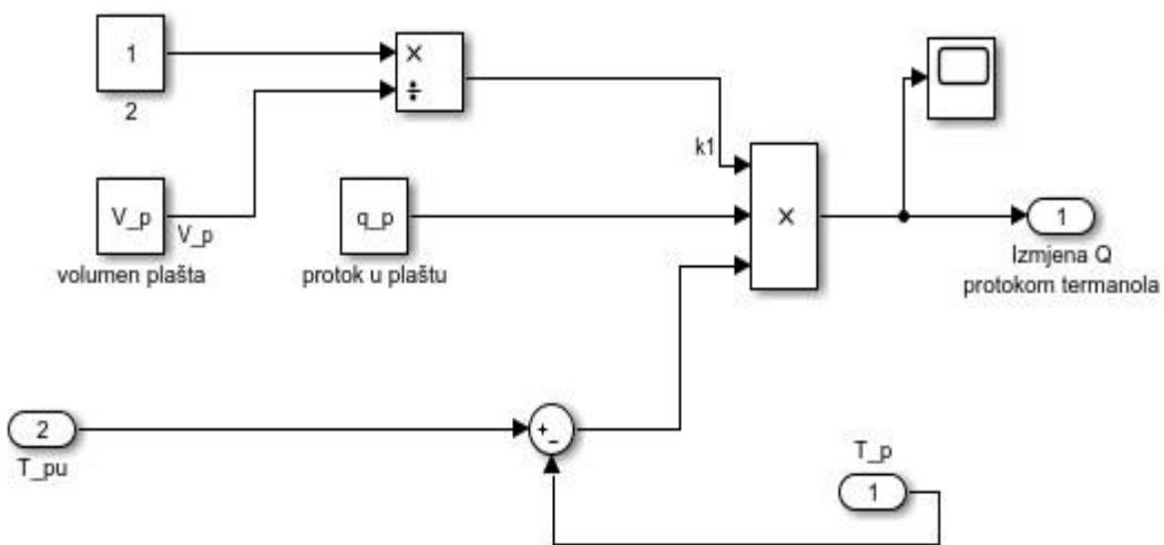
Slika 4.9. Odvod topline iz plašta protokom medija za izmjenu topline
