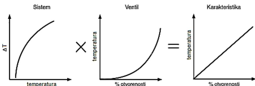
**Slika 2.8.** Kompenzacija statičke osjetljivosti ventila i procesa [6]
