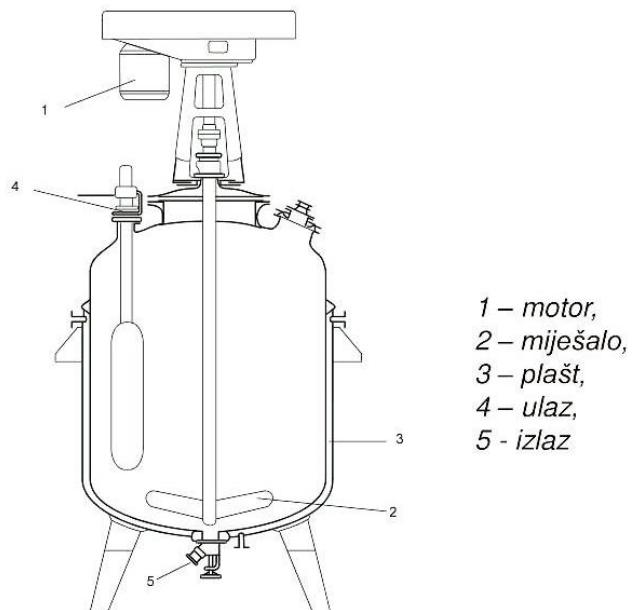
Slika 2.1. Shematski prikaz šaržnog reaktora [5]
