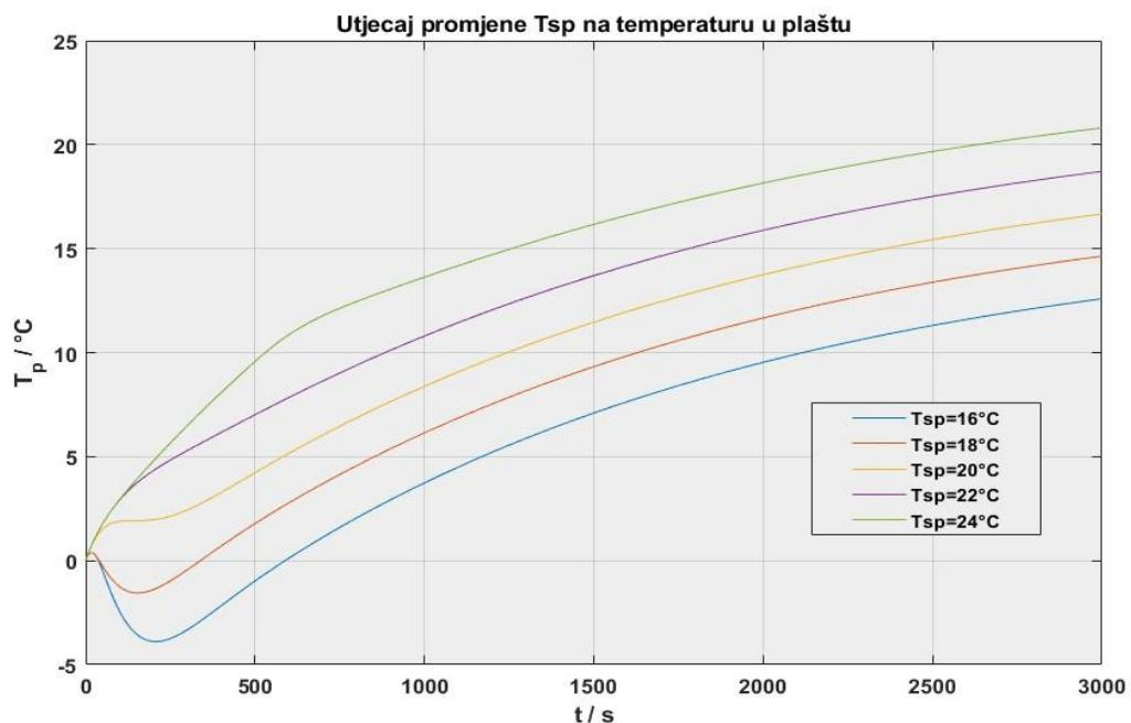
**Slika 4.22.** Utjecaj promjene  $T_{sp}$  na temperaturu u plaštu
