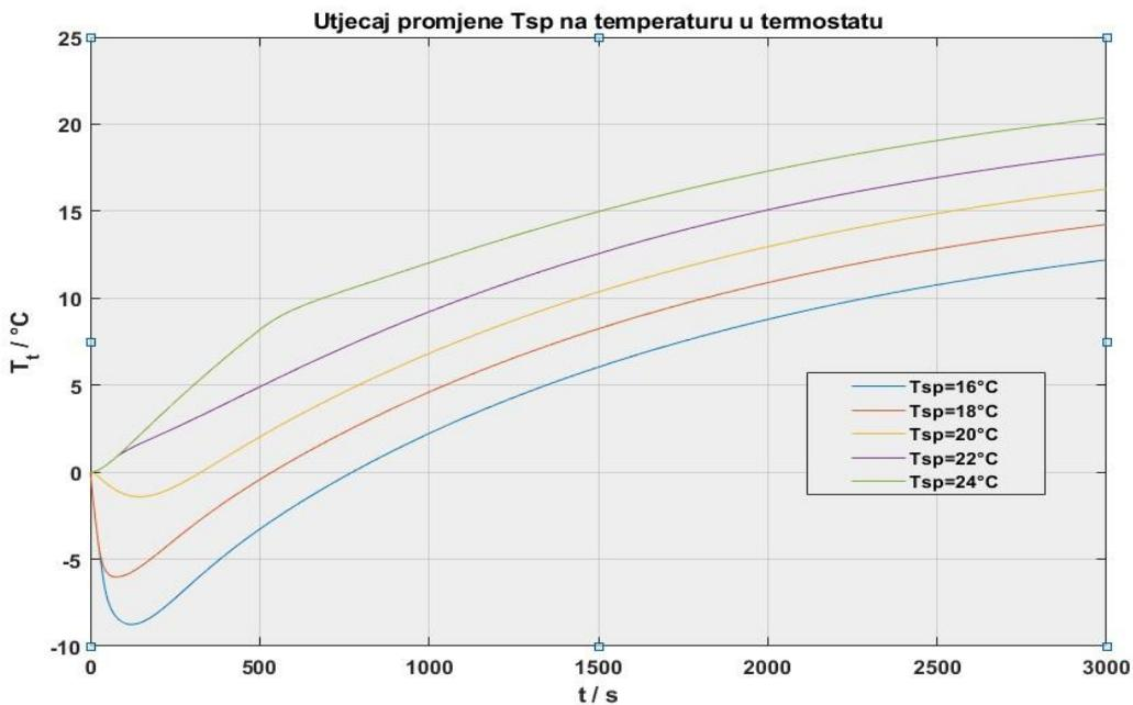
**Slika 4.23.** Utjecaj promjene  $T_{sp}$  na temperaturu u termostatu
