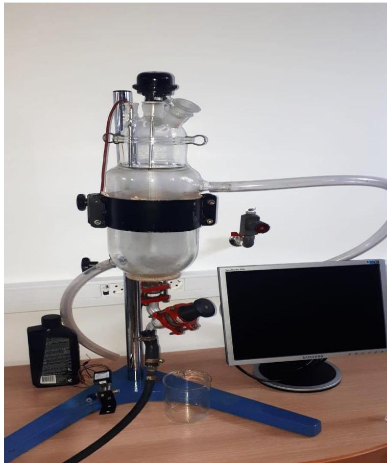
**Slika 3.1.** Laboratorijski šaržni reaktor
