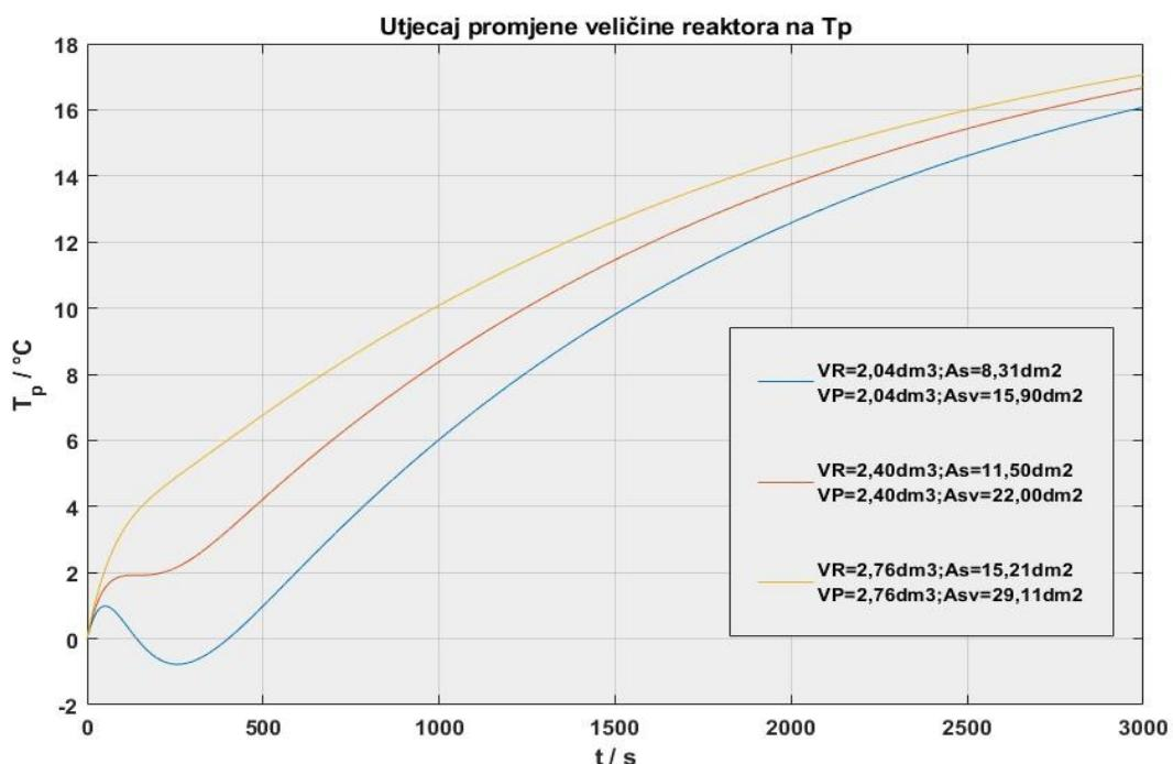
**Slika 4.26.** Utjecaj promjene veličine reaktora na temperaturu u plaštu
