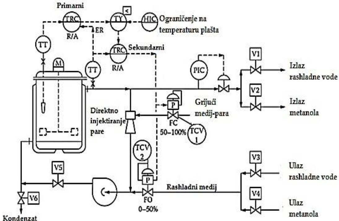
**Slika 2.11.** Primjer primjene kaskadne i podijeljene regulacije
