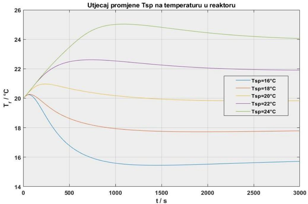
**Slika 4.21.** Utjecaj promjene  $T_{sp}$  na temperaturu u reaktoru
