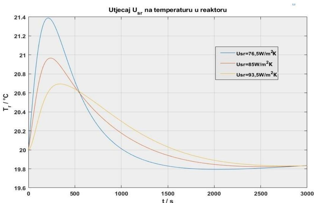
Slika 4.17. Utjecaj promjene  $U_{sr}$  na temperaturu u reaktoru
