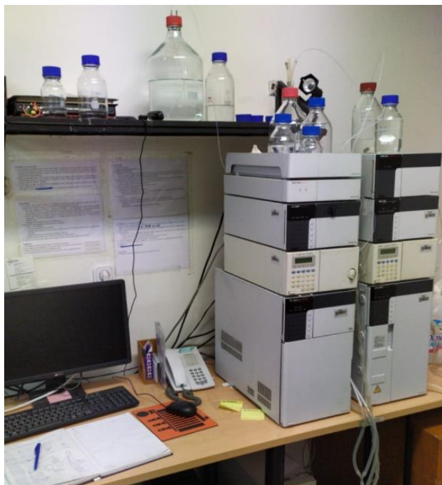
Slika 13. HPLC s UV detektorom, Shimadzu (Japan).
