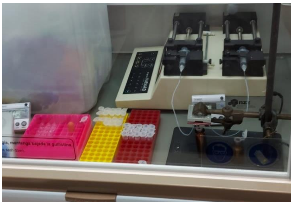
Slika 16. Reakcijski sustav s mikroreaktorom
