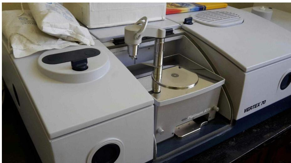
**Slika 11.** FTIR spektrometar - Bruker Vertex 70
