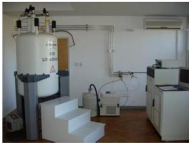
**Slika 12.** NMR Spektrometar Bruker Avance 300
