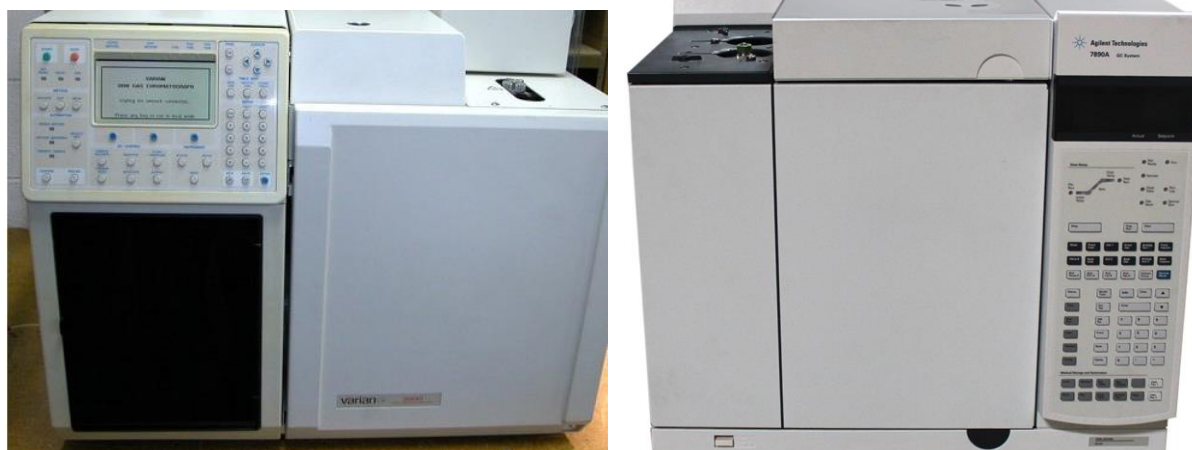
Slika 13. Plinski kromatografi: Varian 3800 i Agilent 7890A
