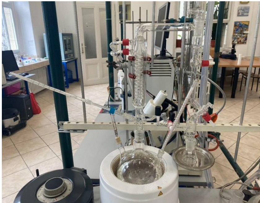
Slika 15. Destilacijska kolona za šaržnu destilaciju
