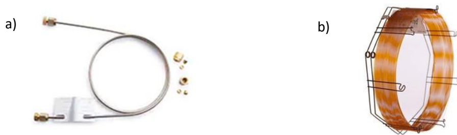
Slika 6. Prikaz GC kolona: a) punjena kolona; b) kapilarna kolona
