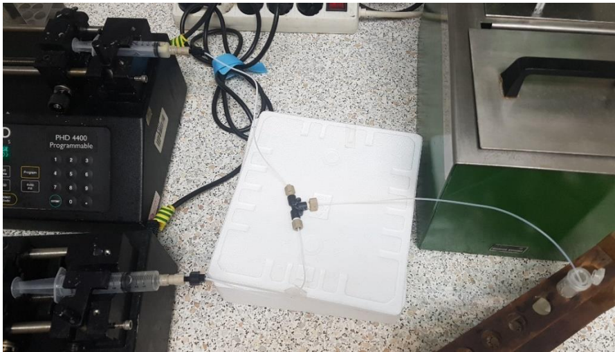
Slika 14. Aparatura za provedbu kontinuirane ekstrakcije enzima lipaza u mikroekstraktoru
