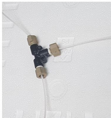
Slika 8. Mikroekstraktor izrađen od PTFE cijevi i plastičnog spojnog elementa u obliku „T“-spojnice
