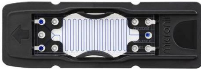
Slika 7. Mikroekstraktor s dva ulaza “Y” oblika i jednim izlazom
