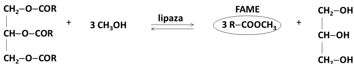
Slika 10. Jednadžba kemijske reakcije transesterifikacije suncokretovog ulja metanolom katalizirana enzimom lipaza
