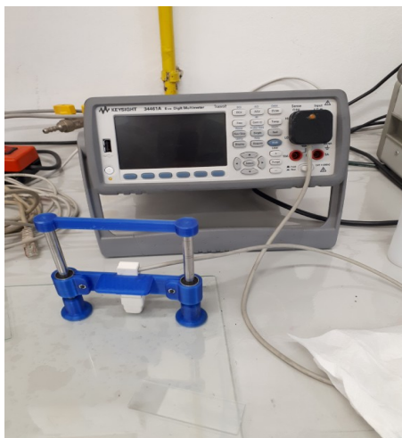
Slika 3.8. Uređaj za mjerenje otpora rGO papira
