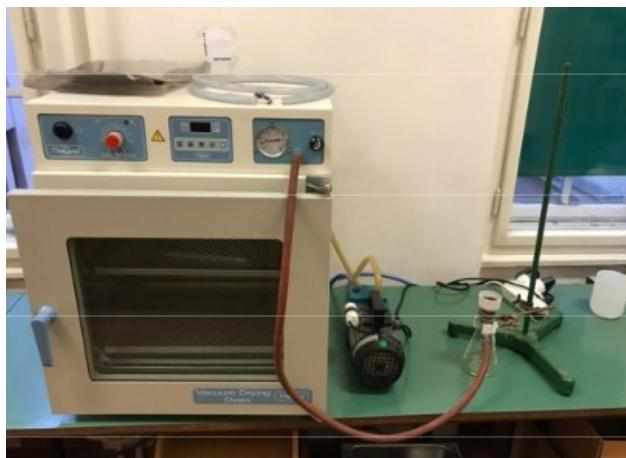
Slika 3.4. Aparatura za vakuum filtraciju
