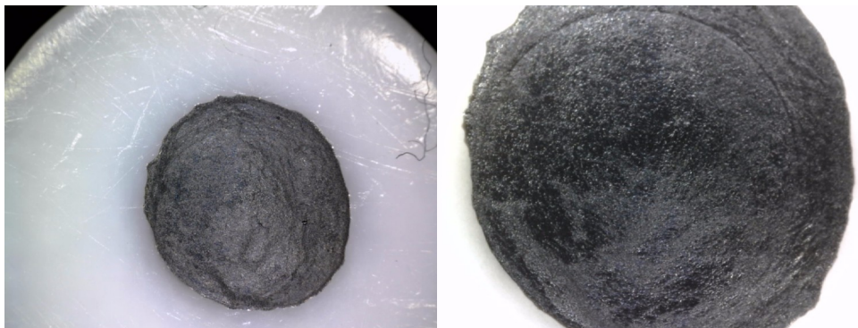
Slika 4.16. Površina GC elektrode na koju je nanesen sloj GO/10%CNT
