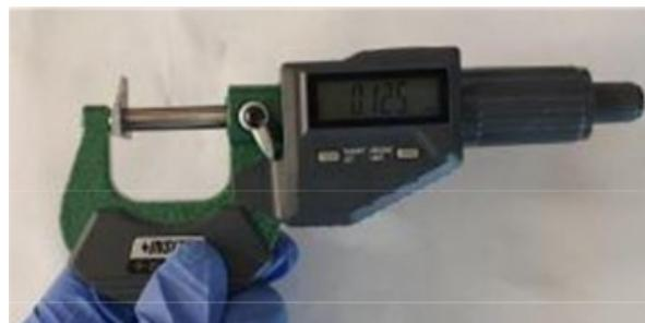
**Slika 3.7.** Mikrometar
