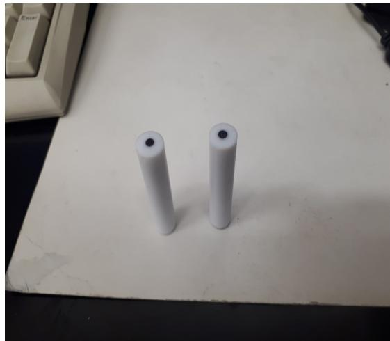
**Slika 3.1.** Disk elektrode od staklastog ugljika
