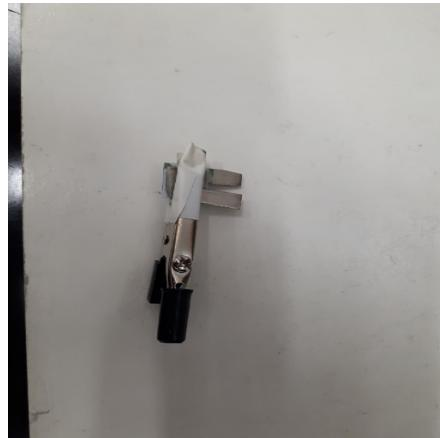
**Slika 3.9.** rGO papir/rGO papir hibridni superkondenzator
