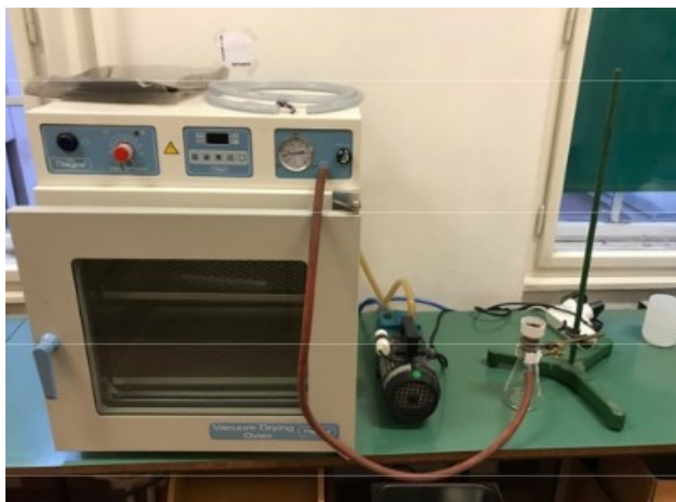
Slika 3.4. Aparatura za vakuum filtraciju
