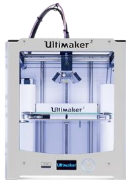
Slika 8. Ultimaker 2 za FFF proizvodnju. [100]
