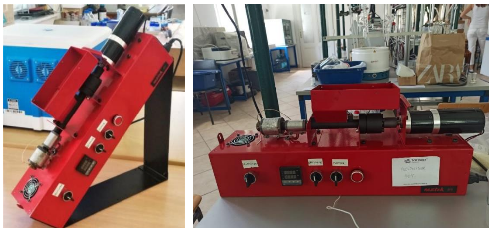
Slika 19. Ekstruder pod kutom od 45° i vodoravno postavljeni ekstruder
