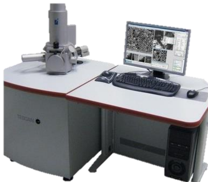
Slika 13. SEM Tescan Vega 3 [35]
