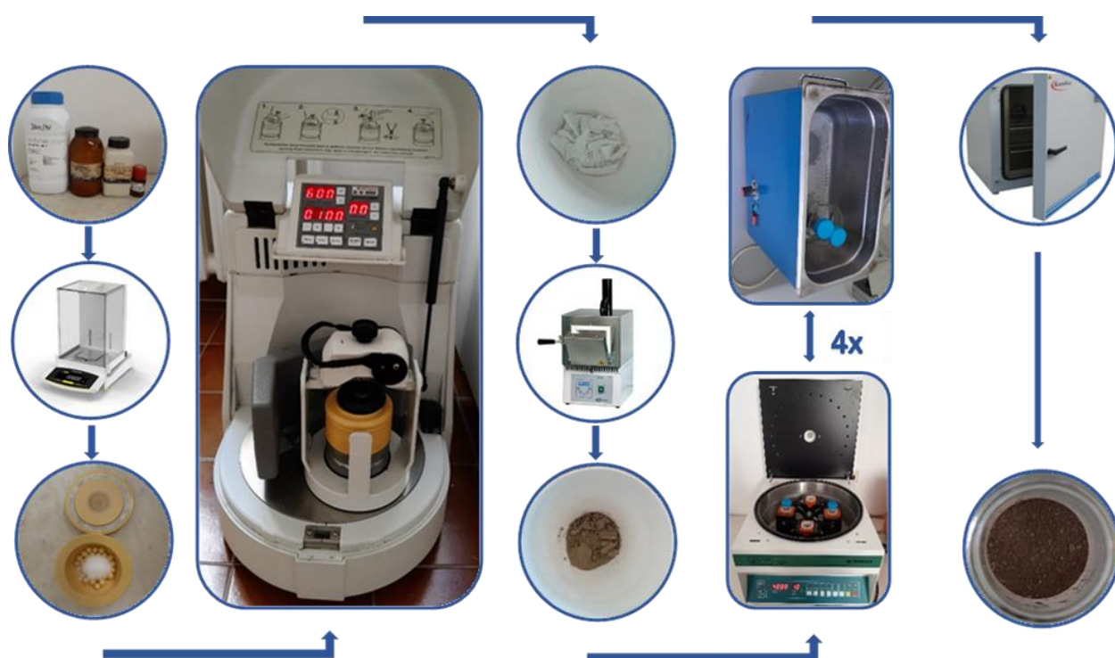
Slika 8. Shematski prikaz mehanokemijske sinteze nanočestica cerijeva(IV) oksida dopiranog manganom
