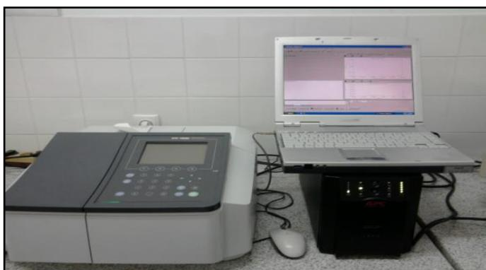
Slika 3.2 Dvozračni spektrofotometar *Shimadzu UV-1800*
