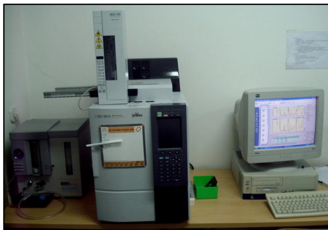
Slika 3.4 Plinski kromatograf Shimadzu GC – 2014 i Parker 9150 generator vodika
