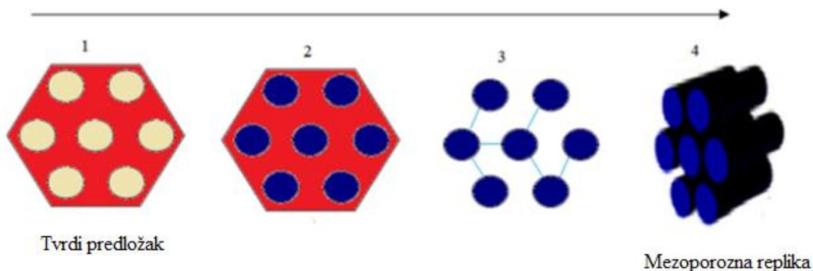
**Slika 13.** Metoda tvrdog predloška (egzopredložak)<sup>[1]</sup>
