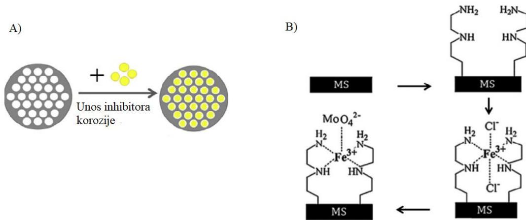
**Slika 22.** Proces unosa inhibitora u pore nanospremnika mezoporozne slike: A) Direktna adicija inhibitora korozije i B) Funkcionalizacija površine mezoporozne slike (oznaka-MS)<sup>[14]</sup>
