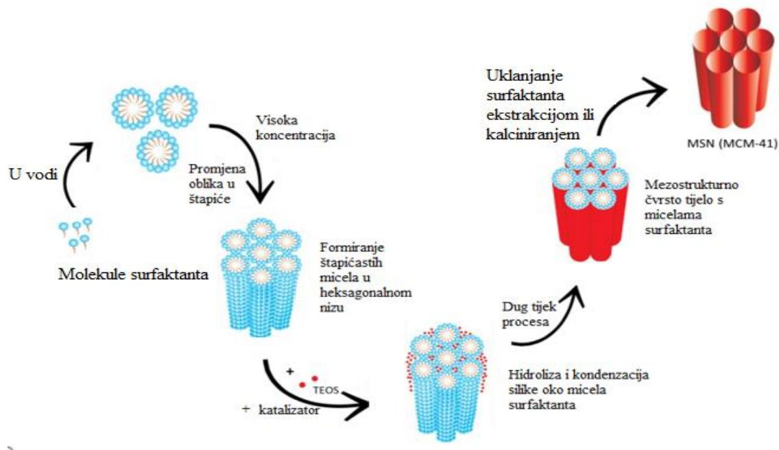
**Slika 11.** Mehanizam priprave MCM-41 sol-gel metodom<sup>[16]</sup>
