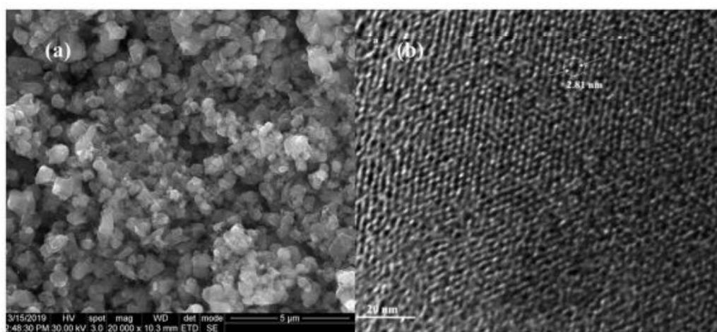
**Slika 12.** Slika MCM-41 snimljena transmisijskom elektronskom mikroskopijom<sup>[24]</sup>
