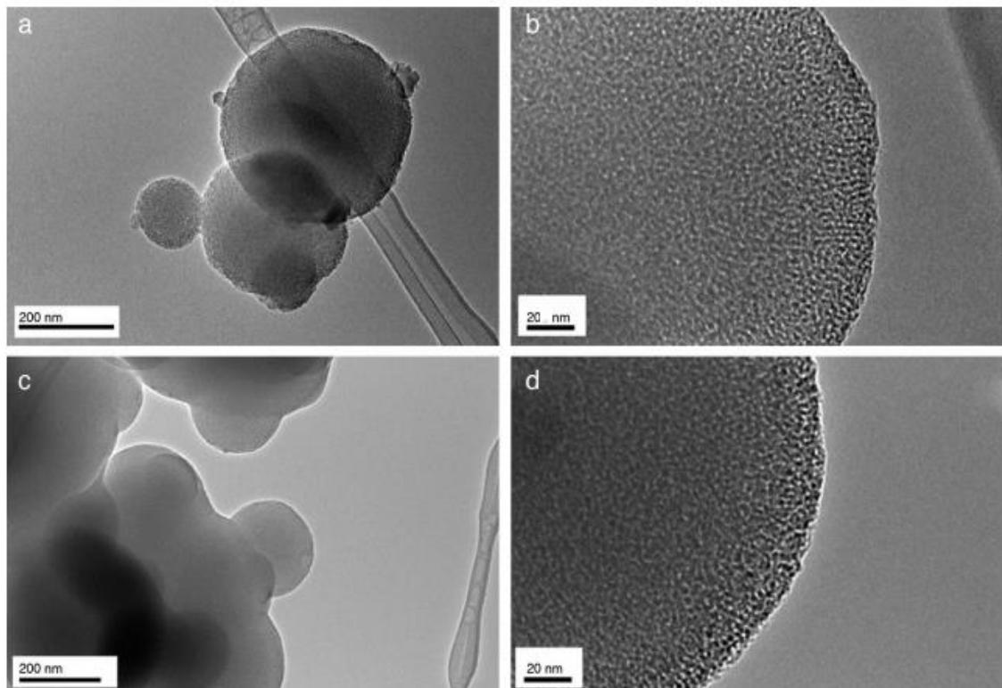
**Slika 17.** HR-TEM mikrografovi mezoporozne silike čestica 0,1CTAB:45H<sub>2</sub>O uzorka(a i b) i 0,3CTAB:45H<sub>2</sub>O uzorka (c i d)<sup>[48]</sup>
