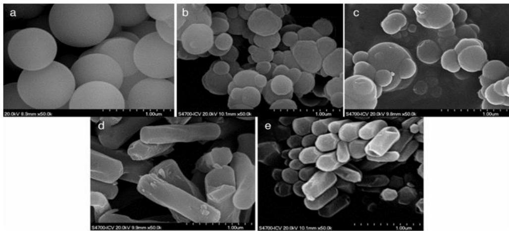
**Slika 16.** FESEM slike mezoporozne silike čestica (a) 0 CTAB:45 H<sub>2</sub>O, (b) 0,1 CTAB:45 H<sub>2</sub>O, (c) 0,3 CTAB:45 H<sub>2</sub>O, (d) 0,3 CTAB: 600H<sub>2</sub>O i (e) 0,3 CTAB:1200H<sub>2</sub>O<sup>[48]</sup>
