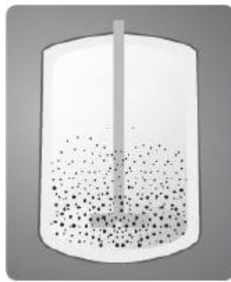
Slika 3. Stanje potpune suspenzije
