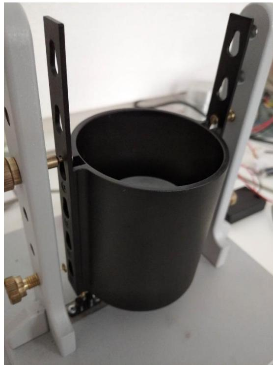
**Slika 8.** Prikaz osi titranja u izvedenoj aparaturi. Trenutno je nosač uzorka (s aluminijskom slitinom koja nije bila korištena kao uzorak u ovome nizu mjerjenja) ovješen oko treće osi, brojeći od vrha.
