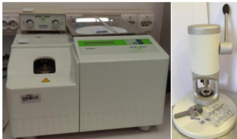
**Slika 21.** DSC uređaj Mettler Toledo DSC 823 (lijevo) i preša (desno)
