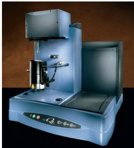
*Slika 22.* TGA uređaj TA Instruments Q500
