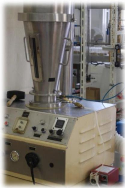
**Slika 14.** Fotografija granulatora s fluidiziranim slojem Uni-Glatt
