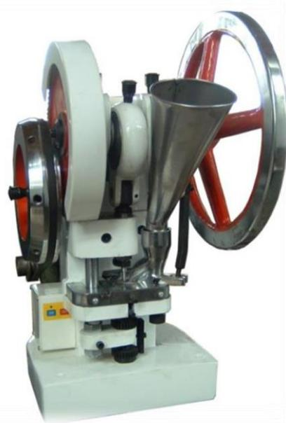
**Slika 15.** Fotografija uređaja za tabletiranje TDP-5T
