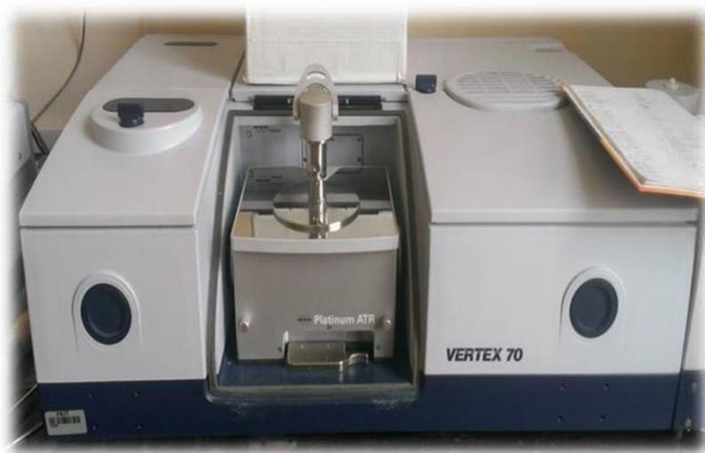
**Slika 18.** Fotografija FTIR spektrofotometra Vertex 70 s platinastim detektorom
