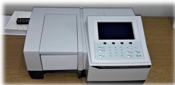
Slika 24. Fotografija spektrofotometra UV-1280 (Shimadzu, Kyoto, Japan)
