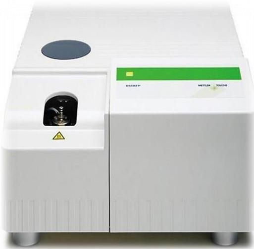
**Slika 17.** Fotografija diferencijalnog pretražnog kalorimetra Mettler Toledo 822<sup>e</sup>
