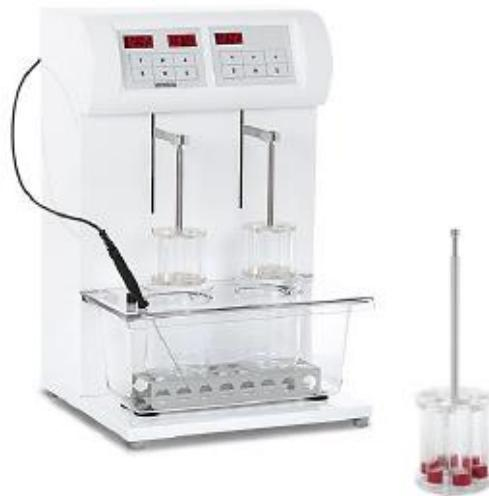
**Slika 23.** Fotografija uređaja za ispitivanje raspadljivosti tabletata/minitableta ZT 322
