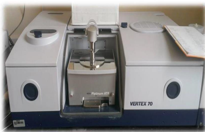
Slika 18. Fotografija FTIR spektrofotometra Vertex 70 s platinastim detektorom (Bruker, Billerica, SAD)
