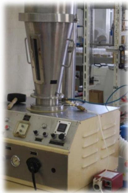
Slika 14. Fotografija granulatora s fluidiziranim slojem Uni-Glatt (Glatt GmbH, Binzen, SR Njemačka)
