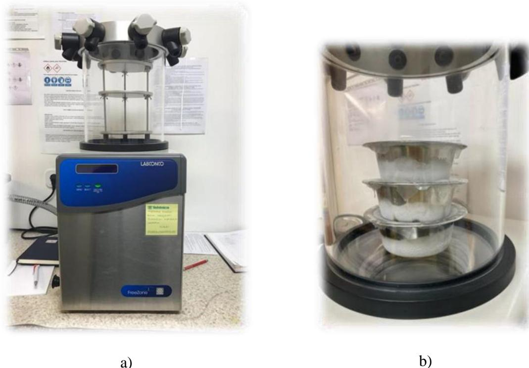
**Slika 12.** a) Fotografija liofilizatora FreeZone 1 (Labconco Co., Kansas City, SAD)
