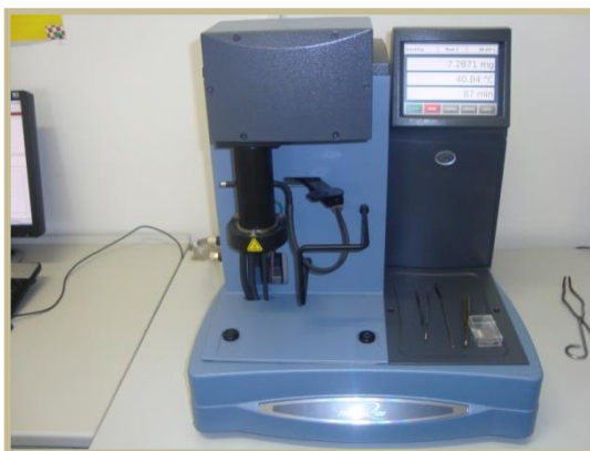
Slika 24. Termogravimetar, TA Instruments Q500
