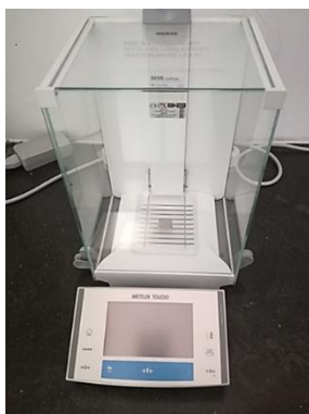
Slika 3.1. Analitička vaga Mettler Toledo XA105DU
