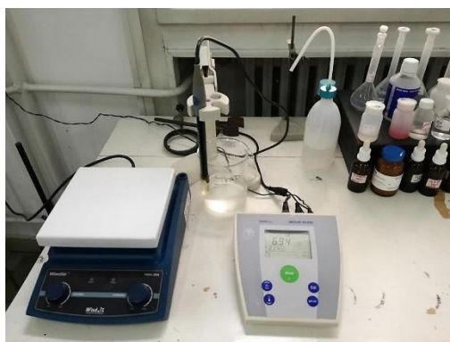
Slika 3.2. pH-metar Mettler Toledo
