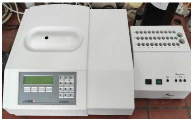
Slika 3.6. Dr. Lange LUMISTox 300 Luminometar
