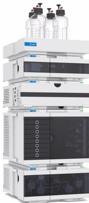
Slika 3.5. HPLC sustav Agilent 1290 Infinity II
