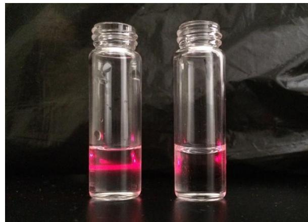
**Slika 35.** Proba na Tyndallov efekt polimernih nanočestica dopiranih bojilom **1**
