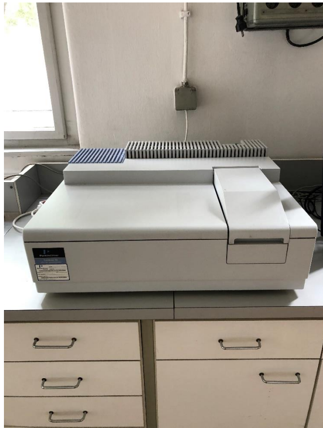
Slika 7. Lambda 35 UV/VIS spectrometer, PerkinElmer
