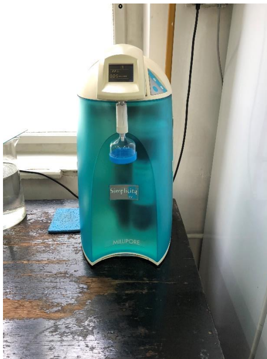
Slika 4. Uređaj za pročišćavanje vode Millipore Simplicity
