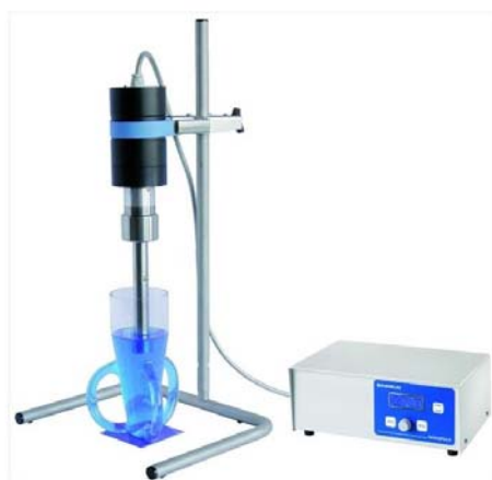
Slika 3.2.1. Ultrazvučni homogenizator Sonopuls HD 3400
