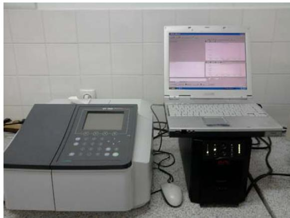
**Slika 3.2.2.** Spektrofotometar Shimadzu UV-1800
