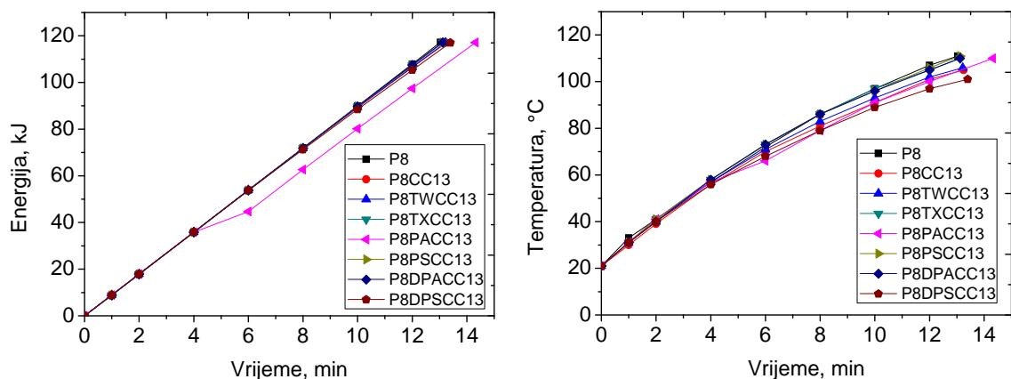
Slika 4.1.2. Predana energija (lijevo) i postignutu temperaturu (desno) prilikom ultrazvučnog homogeniziranja 1. niza eksperimenata sa grafitom
