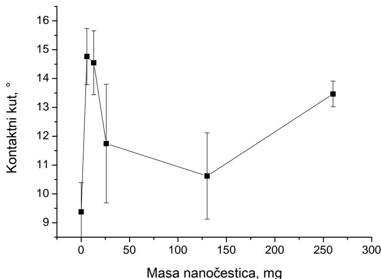
**Slika 4.6.1.** Rezultati mjerenja kontaktnog kuta za staklenu površinu
