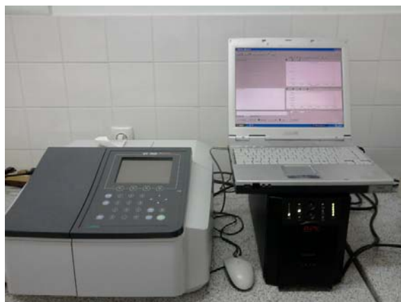
Slika 3.2.2. Spektrofotometar Shimadzu UV-1800
