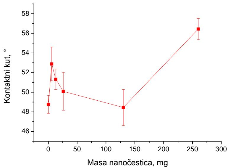
**Slika 4.6.2.** Rezultati mjerena kontaktnog kuta za teflonsku površinu
