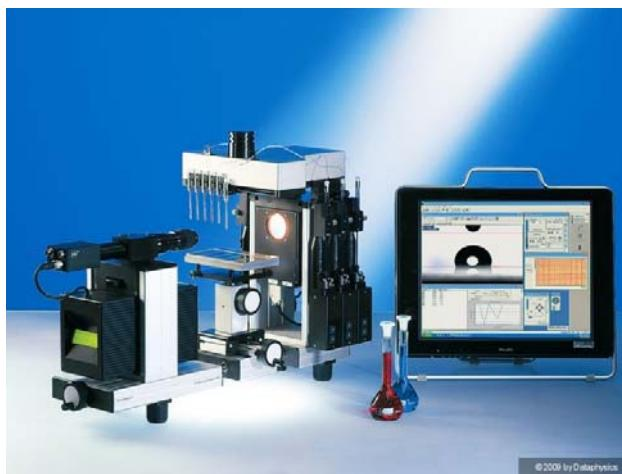
**Slika 3.2.6.** Uređaj za mjerjenje kontaktnog kuta (goniometar)
