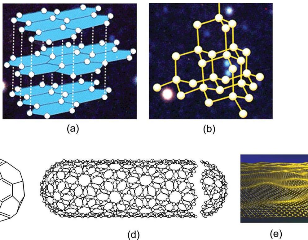
**Slika 2.2.1.** Alotropske modifikacije ugljika : a) grafit, b) dijamant, c) Buckminster fuleren  $C_{60}$ , d) ugljikova nanocijev i e) grafen
