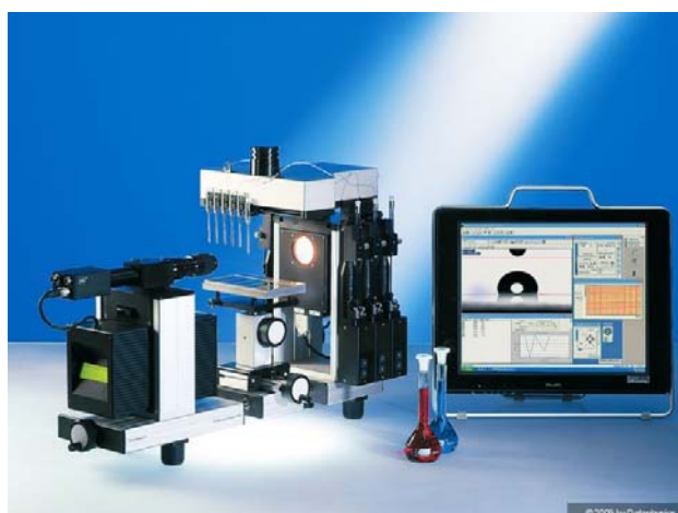
Slika 3.2.6. Uređaj za mjerenje kontaktnog kuta (goniometar)
