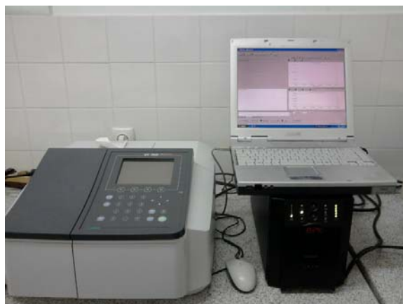
Slika 3.2.2. Spektrofotometar Shimadzu UV-1800
