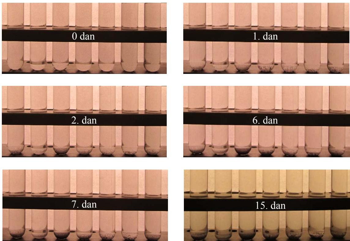
**Slika 4.2.12.** Sedimentacijski test za sustave sa grafitom u prvoj fazi eksperimenata (s lijeva na desno P8CC13, P8TWCC13, P8TXCC13, P8PACC13, P8PSCC13, P8DPACC13 i P8DPSCC13)
