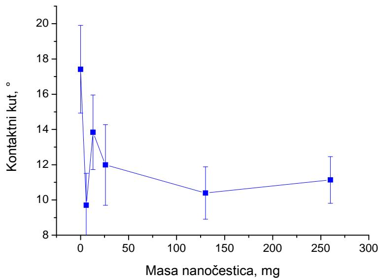
**Slika 4.6.3.** Rezultati mjerena kontaktnog kuta za metalnu površinu
