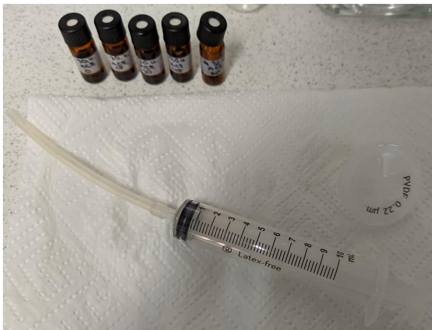
Slika 3.4. Pribor za uzimanje uzoraka
