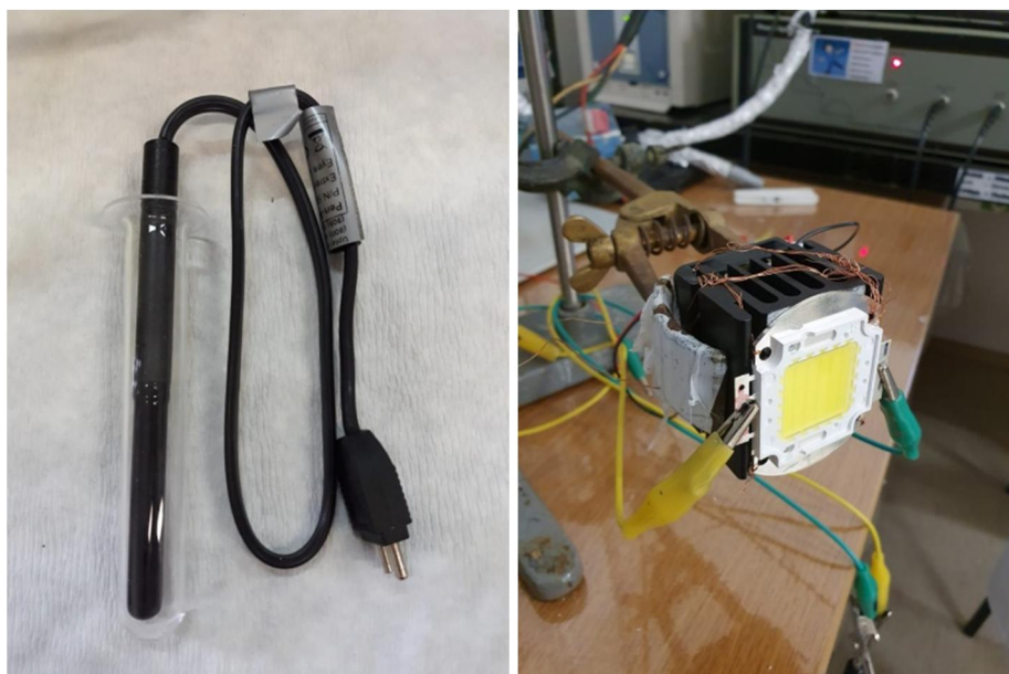
Slika 25. UV i LED lampa korištene tijekom fotoelektrokemijskih mjerenja.
