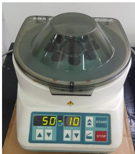
Slika 12.a Centrifuga Centric 32AA (Tehnica) za određivanje stabilnosti NS-a
