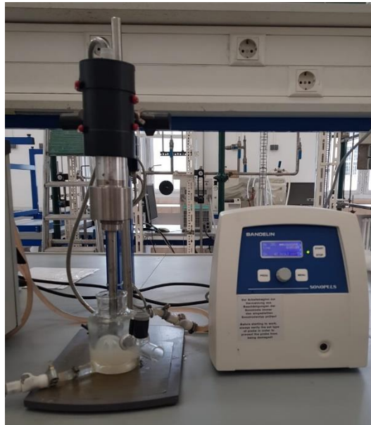
Slika 11. Ultrazvučni homogenizator Bandelin sonoplus HD 3200
