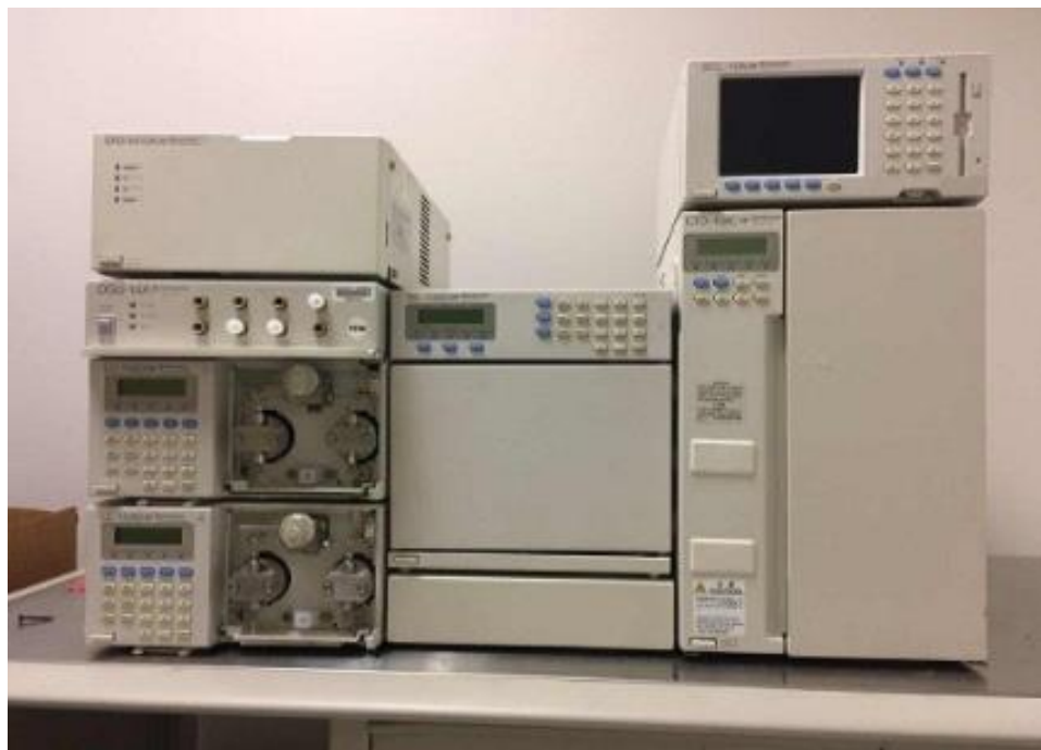
Slika 4.8. Fotografija jedinice za kromatografiju LC-10 (Shimadzu, Kyoto, Japan)
