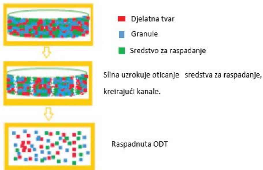
Slika 3.5. Prikaz raspadanja tableta. 8
