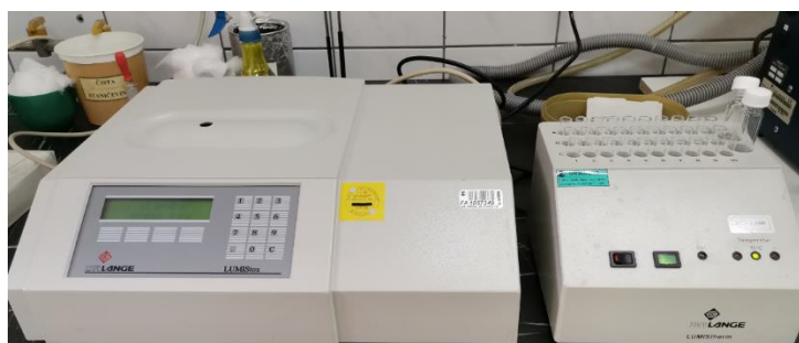
Slika 3.16. Luminometar LUMIStox 300 i termometar LUMIStherm, Hach-Lange GmbH.
