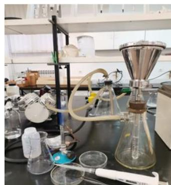
**Slika 3.10.** Membranska filtracija mikroplastike pomoću vakuumskog filter lijevka.
