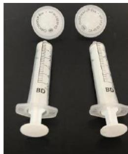
**Slika 3.12.** Prikaz injekcije s filterima promjera 0,45 µm.
