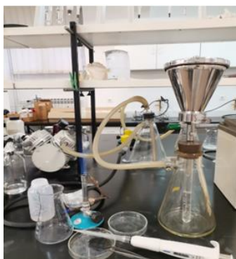
Slika 3.10. Membranska filtracija mikroplastike pomoću vakuuskog filter lijevka.
