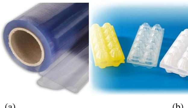
**Slika 2.6.** PVC u obliku folije za hidroizolaciju<sup>39</sup> (a) i ambalaže za jaja<sup>40</sup> (b)
