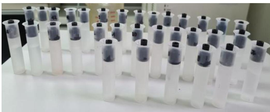
Slika 3.13. Pripremljeni uzorci u vijalama za ionsku kromatografiju.
