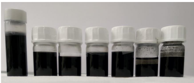
Slika 24. Nemodificirane MWCNT u etanolu sa SOLSPERSE stabilizatorom i sinergistom, početne koncentracije 3, 4, 5, 6, 8, 10, 15 mg mL -1 , uslikano 5 dana nakon homogenizacije.
