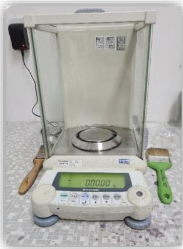
*Slika 3.5.* Analitička vaga *Shimadzu*
