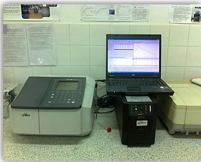
*Slika 3.4.* Spektrofotometar *Shimadzu UV-1800*
