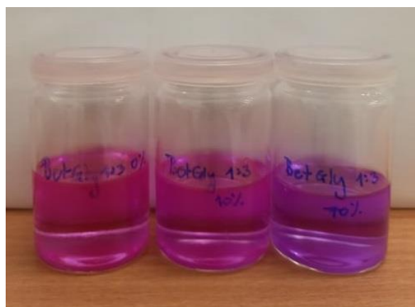
Slika 13. Pripremljeni uzorci za određivanje električne provodnosti za Bet:Gly 1:3 (s lijeva na desno udio vode 0%, 10% i 70%)
