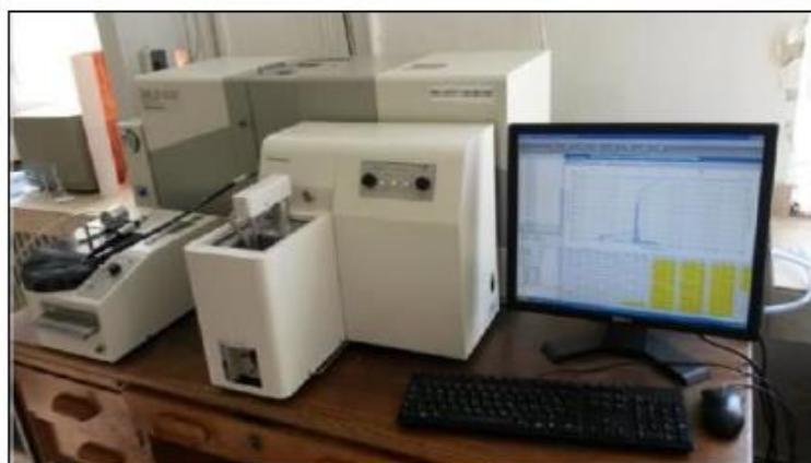
**Slika 20.** Uređaj Shimatzu Sald 3101 za određivanje RVK
