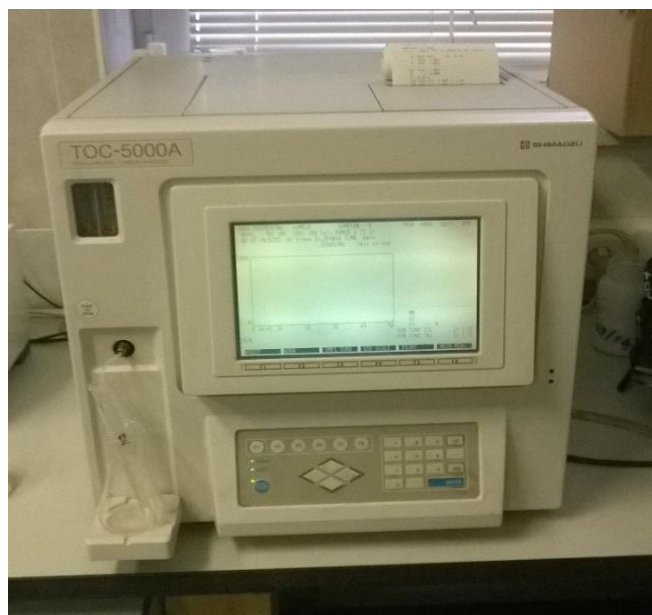
Slika 17. TOC analizator tipa TOC-5000 A, proizvođač je Shimadzu, sa infracrvenim detektorom
