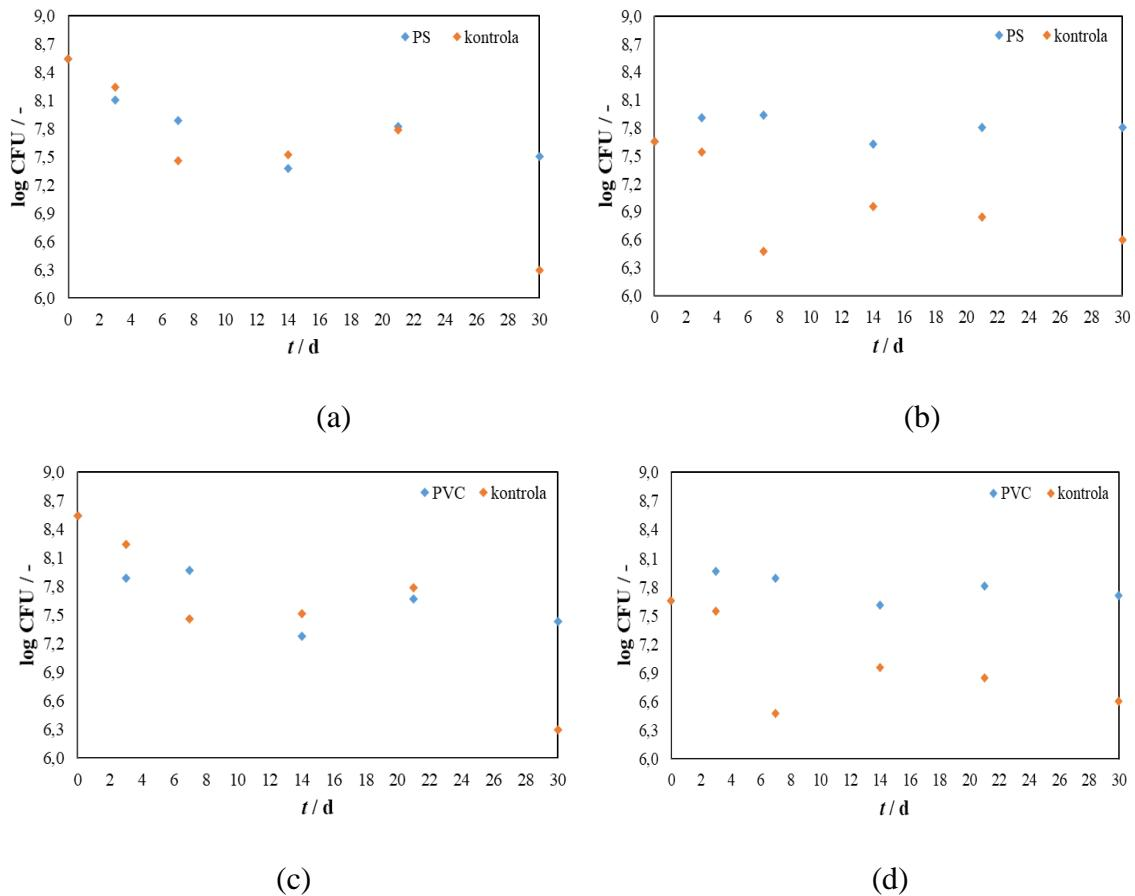
**Slika 4.2.** Promjena vrijednosti CFU tijekom biorazgradnje PS i PVC bakterijskom kulturom *Pseudomonas alcaligenes* za pokuse: (a) P1-4, (b) P1-3, (c) P1-12, (d) P1-11 ( $T = 15^{\circ}\text{C}$ ).
