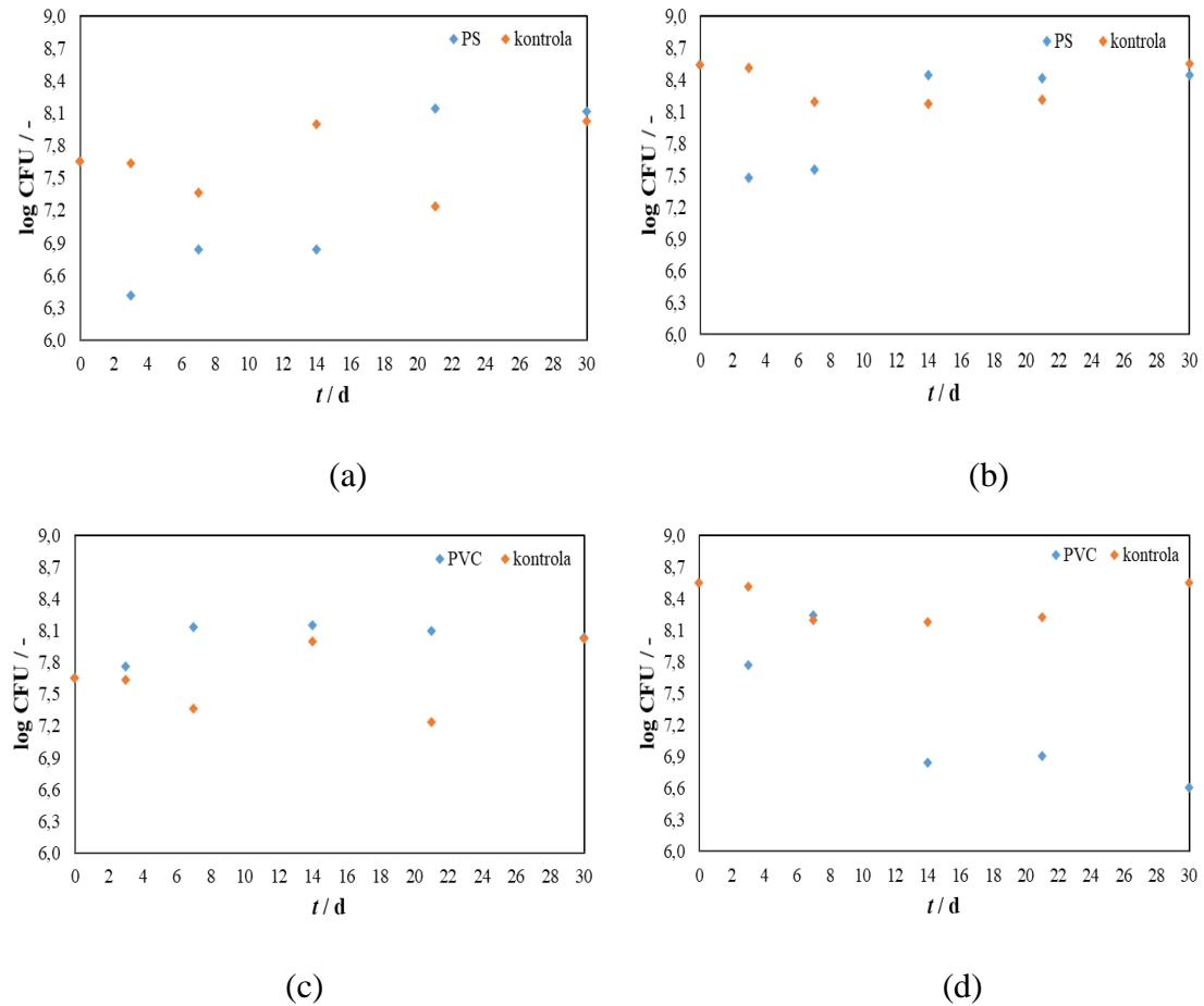
**Slika 4.4.** Promjena vrijednosti CFU tijekom biorazgradnje PS i PVC bakterijskom kulturom *Pseudomonas alcaligenes* za pokuse: (a) P1-7, (b) P1-8, (c) P1-15, (d) P1-16 ( $T = 25^\circ\text{C}$ ).
