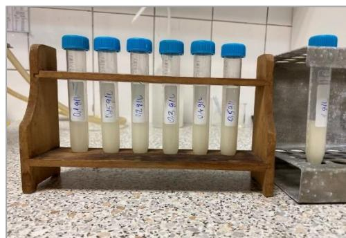
Slika 22. Ispitivanje utjecaja koncentracije emulgatora SDS-a na stabilnost emulzija – izgled emulzija neposredno nakon priprave
