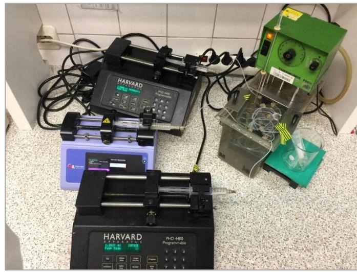
Slika 13. Aparatura za provedbu sinteze biodizela u mikroreaktoru s tri ulaza opremljenim sa spojnicom +-oblika
