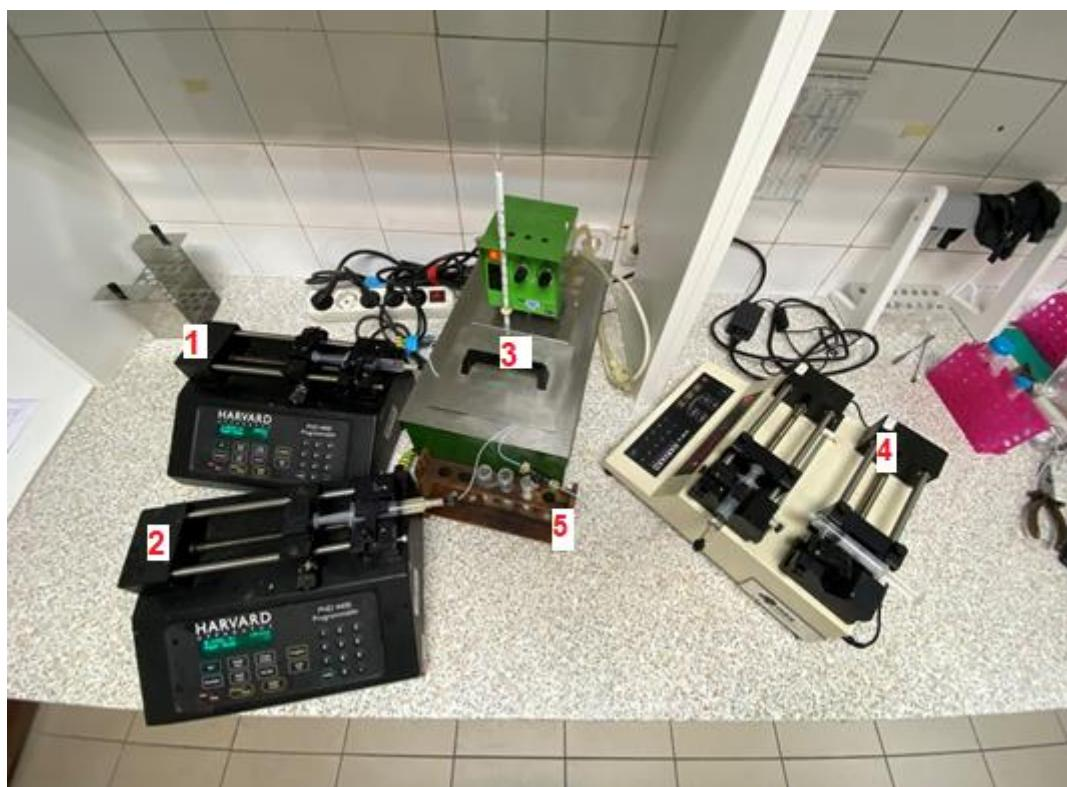
Slika 15. Termostatirani integrirani sustav za sintezu biodizela enzimatskom transesterifikacijom i pročišćavanje biodizela eutektičkim otapalom (1 – pumpa za metanol, 2 – pumpa za emulziju, 3 – vodena kupelj s regulacijom temperature, 4 – pumpa za DES, 5 – sakupljanje uzorka)
