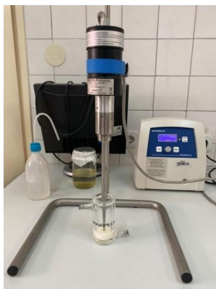
Slika 11. Ultrazvučna sonda (Bandelin Sonoplus HD 3100, Njemačka)
