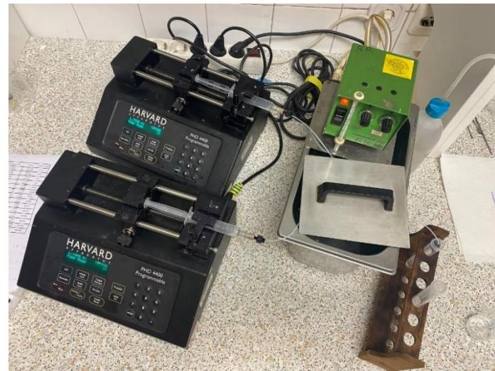
Slika 14. Aparatura za provedbu sinteze biodizela u mikroreaktoru s dva ulaza opremljenim sa spojnicom T-oblika
