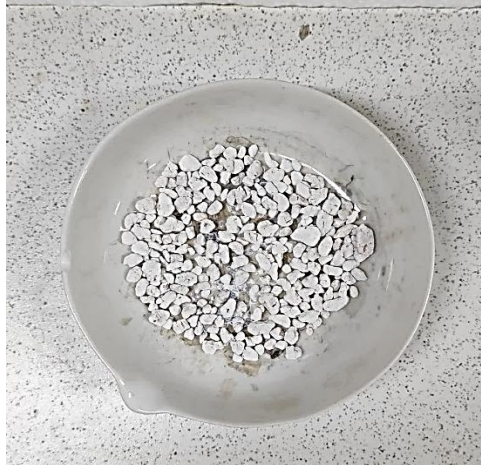
Slika 8. Katalizator na bazi perlita dobiven metodom impregnacije (-1)
