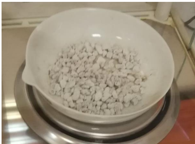
Slika 10. Katalizator na bazi perlita dobiven sol-gel metodom (1)
