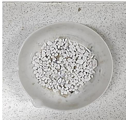
**Slika 8.** Katalizator na bazi perlita dobiven metodom impregnacije (-1)
