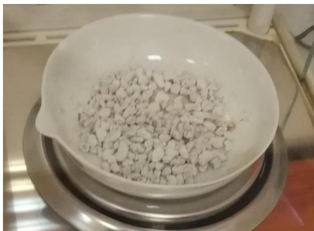
**Slika 10.** Katalizator na bazi perlita dobiven sol-gel metodom (1)
