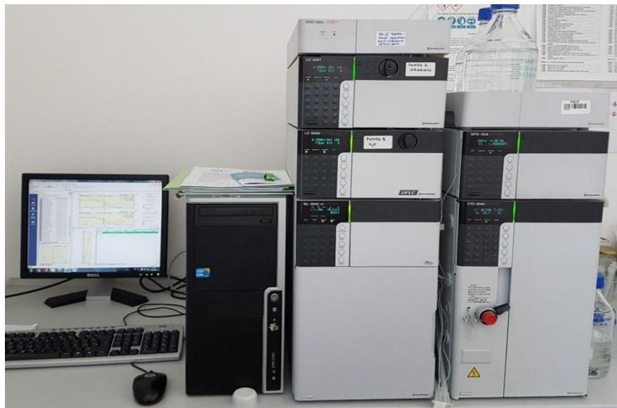
**Slika 12.** Uredaj za tekućinsku kromatografiju visoke djelotvornosti (HPLC uređaj)
