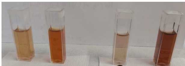
Slika 4.15. Kivete sa uzorcima čiji su spektri prikazani na slici 4.14., redom slijeva suspenzija I 1 i I 2 u EtOH, potom desno suspenzija I 1 i I 2 u IzoOH
