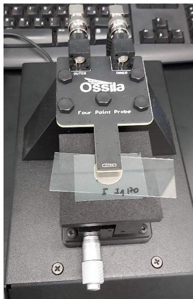
Slika 3.11. Sonda za mjerenje otpora u četiri točke
