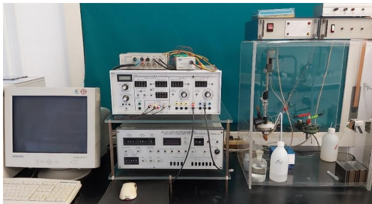
Slika 3.4. Aparatura za cikličku voltametriju
