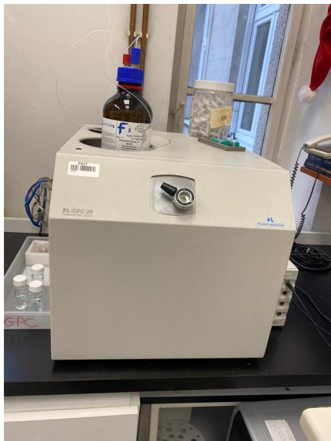
**Slika 18.** Uredaj za kromatografiju isključenjem PL-GPC 20 Polymer Laboratories
