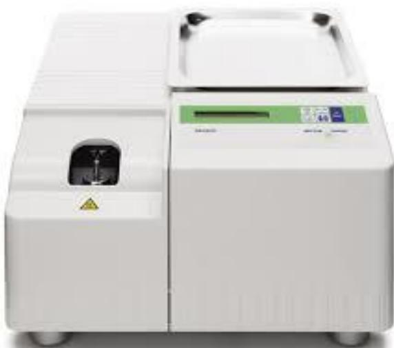
**Slika 14.** Diferencijalni pretražni kalorimetar Mettler Toledo DSC823e [19]
