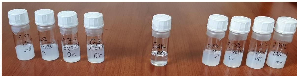
**Slika 32.** Otopljeni PAK i PAK/TiO<sub>2</sub> *ex situ* i *in situ* filmovi u THF-u prije UV zračenja
