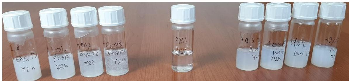
**Slika 34.** Neotopljeni PAK i PAK/TiO<sub>2</sub> *ex situ* i *in situ* filmovi u THF-u nakon 72 sata UV zračenja
