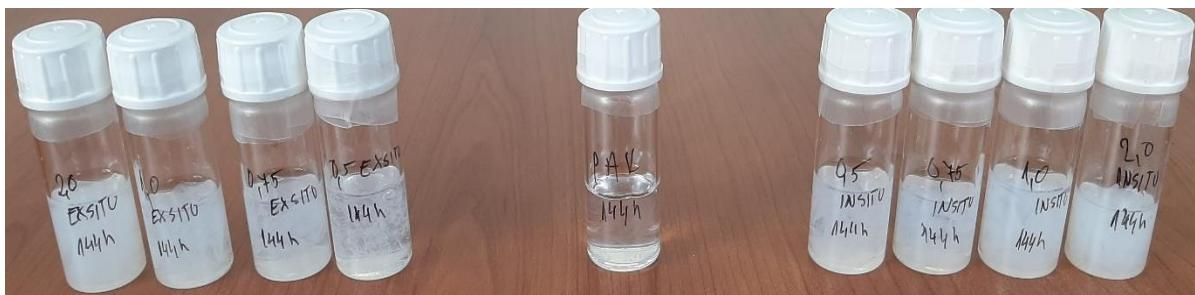
**Slika 35.** Neotopljeni PAK i PAK/TiO<sub>2</sub> *ex situ* i *in situ* filmovi u THF-u nakon 144 sata UV zračenja
