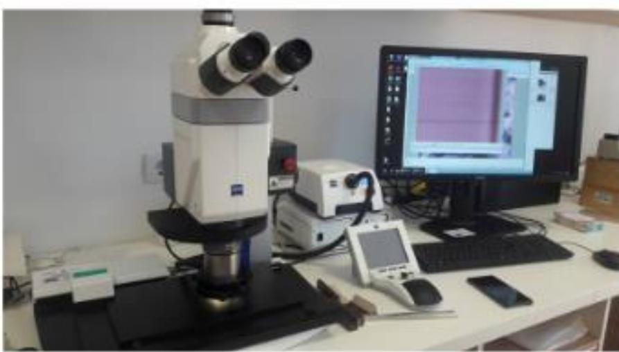
**Slika 11.** Optički mikroskop Axio Zoom V16 tvrtke Zeiss
