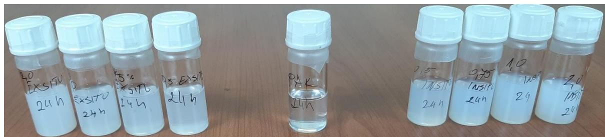
**Slika 33.** Otopljeni PAK i PAK/TiO<sub>2</sub> *ex situ* i *in situ* filmovi u THF-u nakon 24 sata UV zračenja
