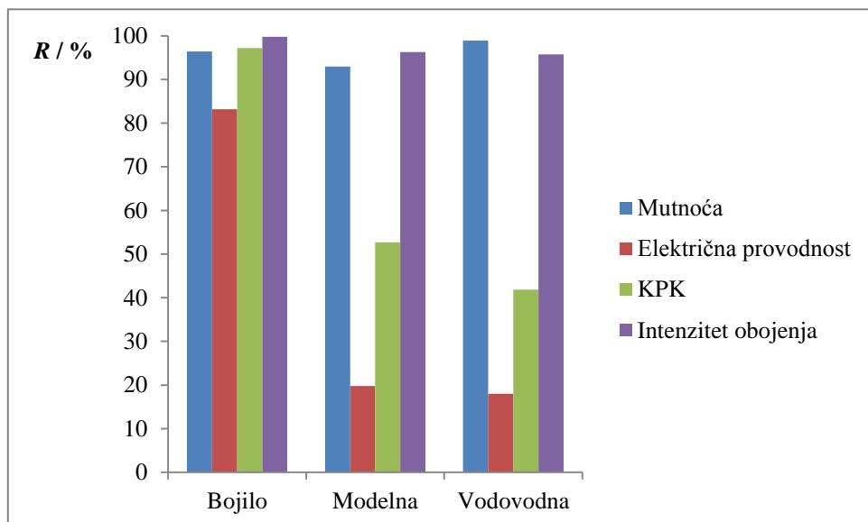
**Slika 9.** Rezultati uklanjanja bojila i onečišćivila iz otopina 5 kDa membranom.
