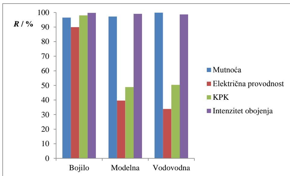
**Slika 8.** Rezultati uklanjanja bojila i onečišćivila iz otopina 3 kDa membranom.
