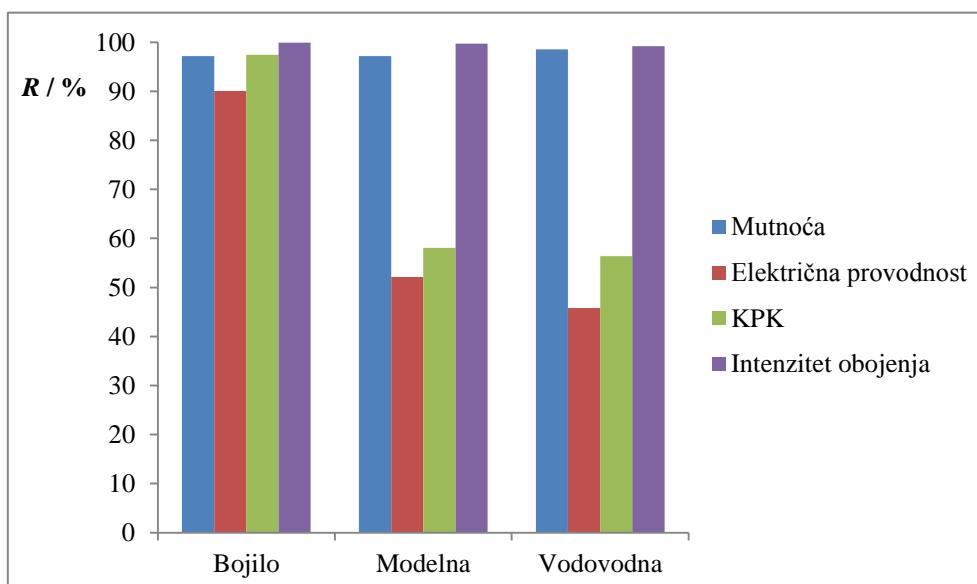
**Slika 7.** Rezultati uklanjanja bojila i onečišćivila iz otopina 2 kDa membranom.
