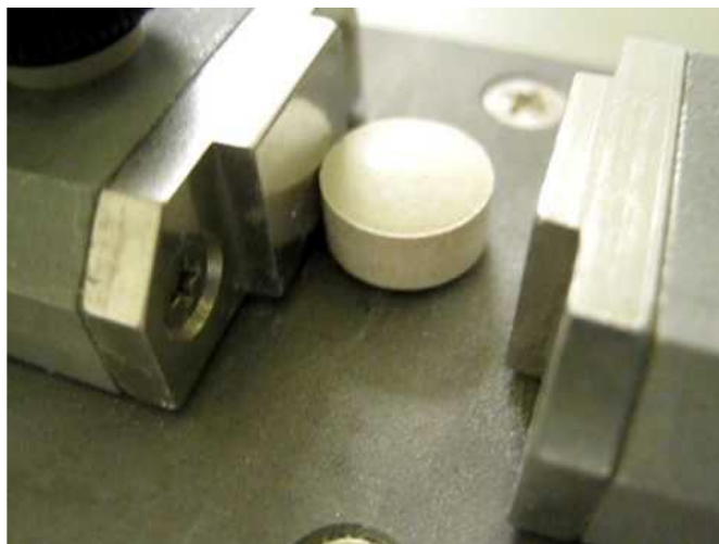
Slika 4.24. Fotografija uređaja za ispitivanje tvrdoće tableta Erweka TBH 325 (Dechra Pharmaceuticals, Zagreb).
