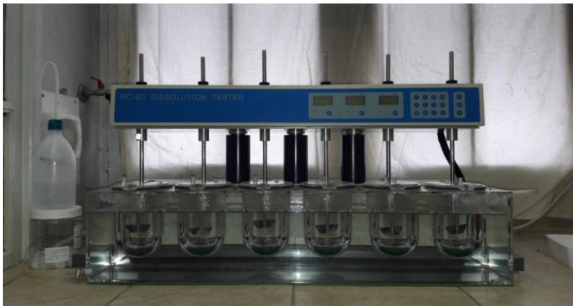
**Slika 4.27.** Fotografija uređaja za određivanje profila oslobođanja djelatne tvari RC-6D (Zhengzhou Nanbei Instruments, Zhengzhou, NR Kina).
