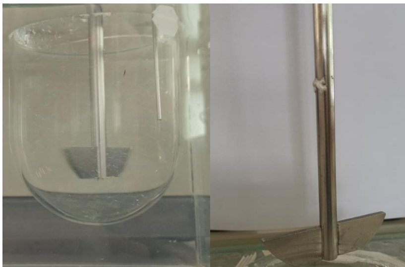
Slika 5.27. Zaostale čvrste čestice na stjenkama posude i na miješalu nakon 120 minuta.
