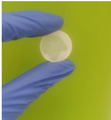
**Slika 4.21.** Prikaz heterogenosti tablete korištene za određivanje kontaktnog kuta.
