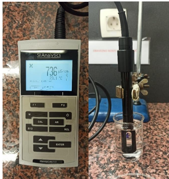
Slika 4.7. Konduktometar SI Analytics HandyLab200 sa konduktometrijskom ćelijom SI Analytics LF431T.
