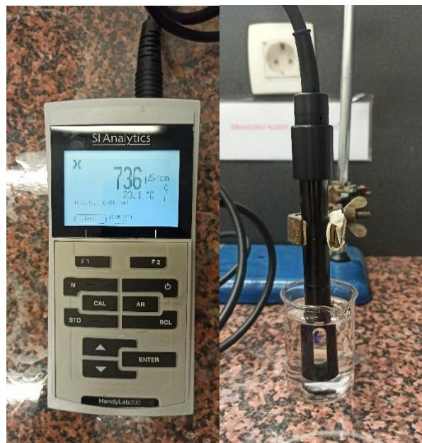
**Slika 4.7.** Konduktometar SI Analytics HandyLab200 sa konduktometrijskom čelijom SI Analytics LF431T.
