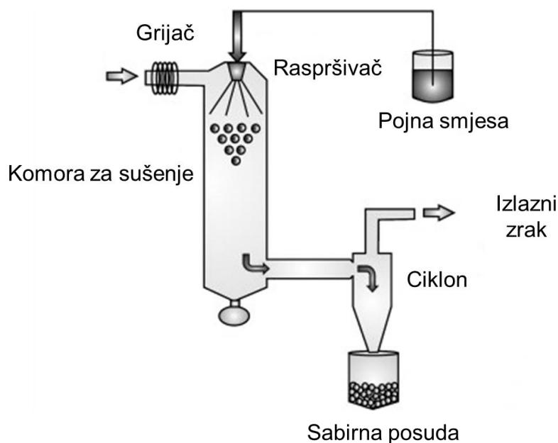
Slika 3.2. Shematski prikaz sušenja raspršivanjem.<sup>17</sup>
