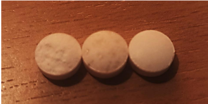
Slika 5.14. Fotografija tablete s defektom „cappinga“, tablete s gelom i dobro pripravljene tablete (TSD 50 I, BSD SDS i BPM SDS).
