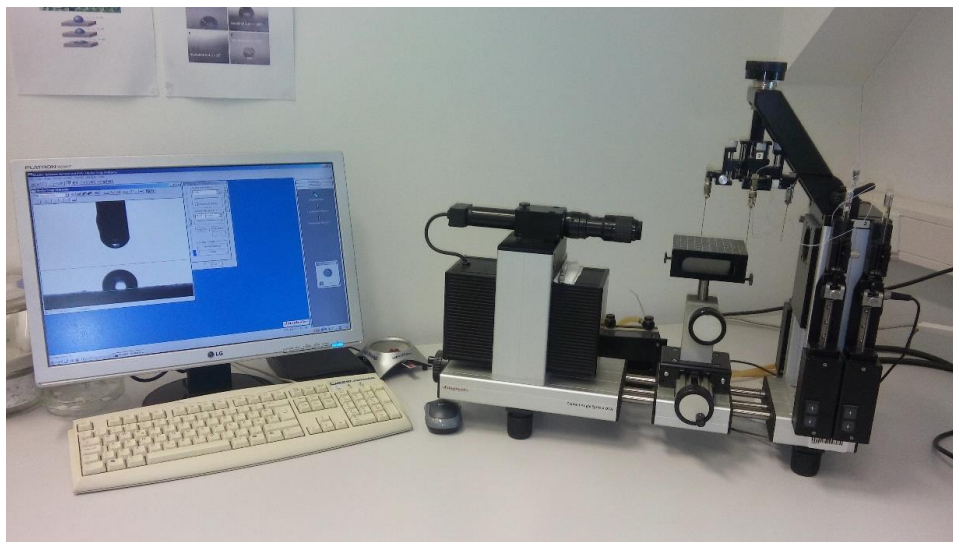
Slika 4.22. Fotografija uređaja za određivanje kontaktnog kuta, goniometar OCA 20 (DataPhysics Instruments GmbH, Filderstadt, SR Njemačka).
