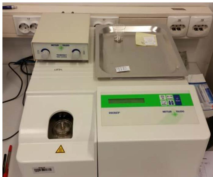
**Slika 4.16.** Diferencijalni pretražni kalorimetar Mettler Toledo 822<sup>e</sup> (Mettler Toledo GmbH, Greifensee, Švicarska).
