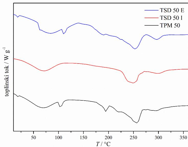
**Slika 5.4.** DSC termogrami ternarnih čvrstih disperzija i fizičkih mješavina omjera djelatne tvari i polimera 50:50.
