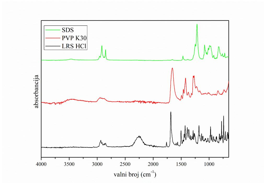
**Slika 5.8.** FTIR spektri lurasidon-hidroklorida, poli(vinil-pirolidona) i natrijevog dodecil-sulfata).
