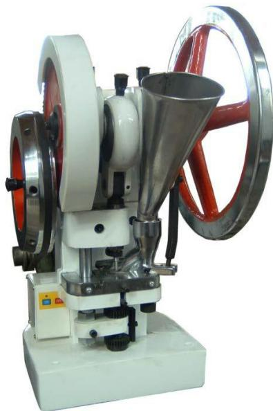
**Slika 4.14.** Fotografija uređaja za tabletiranje TDP-5T (Zhejiang Wisley Machinery Co. Ltd. Zhejiang, NR Kina).
