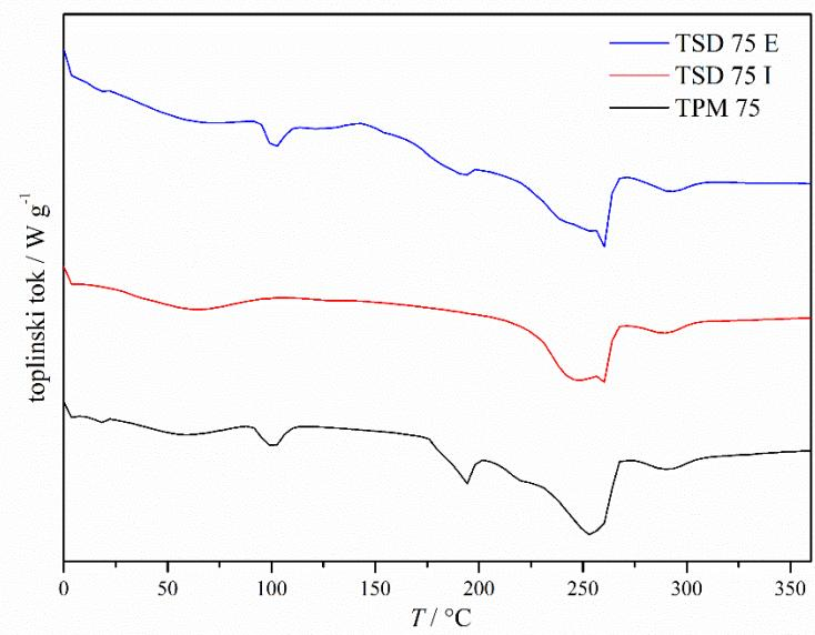
**Slika 5.5.** DSC termogrami ternarnih čvrstih disperzija i fizičkih mješavina omjera djelatne tvari i polimera 75:25.
