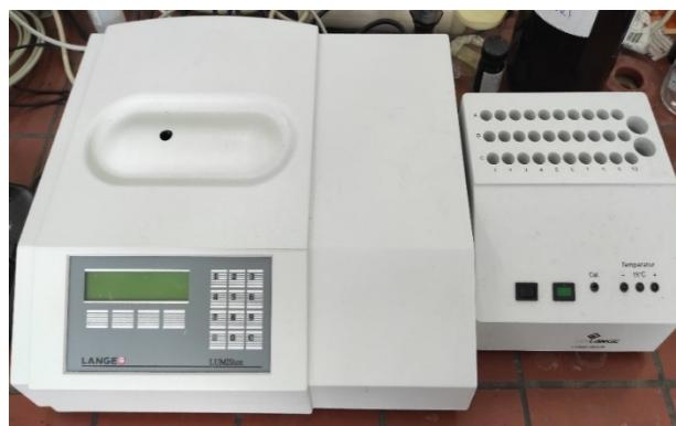
**Slika 20.** Hach Lange LUMIStox 300 luminometar
