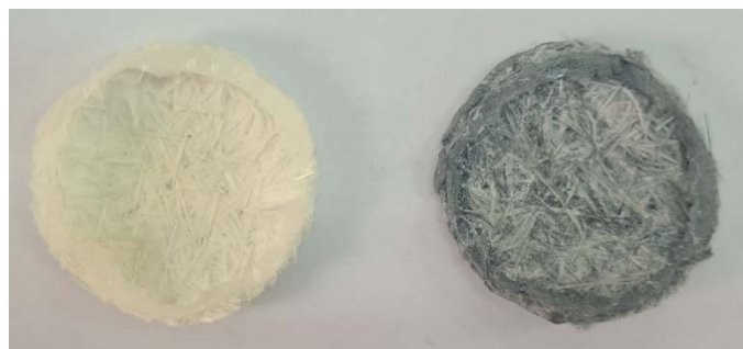
Slika 13. TiO 2 (lijevo) i TiO 2 /CNT (desno) imobilizirani na staklenu mrežicu za eksperimente sorpcije
