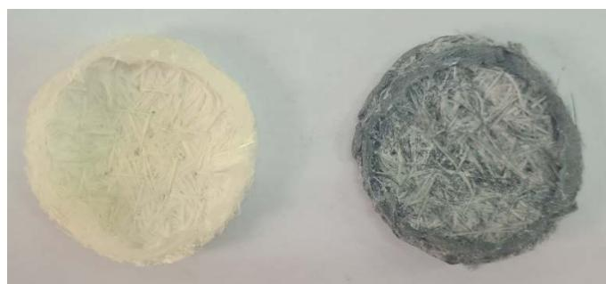
**Slika 13.** TiO<sub>2</sub> (lijevo) i TiO<sub>2</sub>/CNT (desno) imobilizirani na staklenu mrežicu za eksperimente sorpcije
