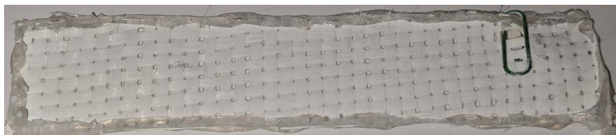
Slika 14. TiO 2 fotokatalizator imobiliziran na staklenu mrežicu
