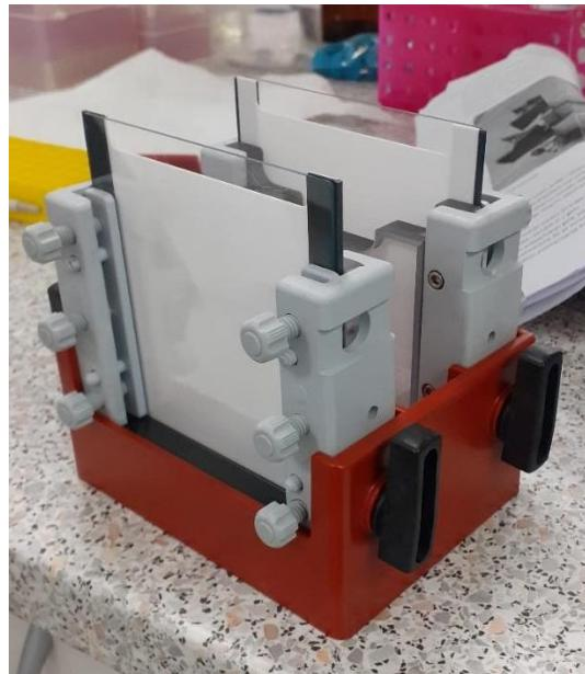
*Slika 10.* Aparatura za elektroforezu
